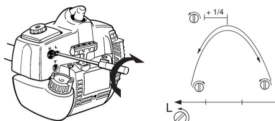
**REMARQUE!** Si les lames tournent au ralenti, tourner le pointeau de ralenti T dans le sens contraire des aiguilles d'une montre jusqu'à l'arrêt des lames.
