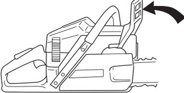
Die Schienenmuttern lösen und den Kupplungsdeckel (Kettenbremse) abnehmen. Den Transportschutz (A) entfernen.
