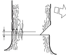
Die Rindenstütze (falls montiert) hinter dem Brechmaß ansetzen. Mit Vollgas sägen und mit der Sägekette/Führungsschiene langsam in den Baumstamm schneiden. Aufpassen, ob sich der Baumstamm entgegengesetzt zur Fällrichtung bewegt. Einen Fällkeil oder einen Fällheber in den Fällschnitt schieben, sobald die Schnitttiefe dies gestattet.
