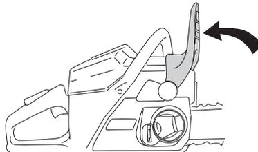
Knauf und Kupplungsdeckel (Kettenbremse) entfernen. Transportring abnehmen.
