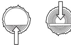
**Der Stamm wird an beiden Enden gestützt.** Es besteht große Gefahr, dass die Sägekette eingeklemmt wird.
