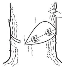
Man verliert völlig die Kontrolle über die Fallrichtung des Baumes, wenn das Brechmaß zu klein oder durchgesägt ist oder wenn Kern- und Fällschnitt an falscher Stelle ausgeführt wurden.
