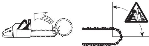
Das Sägen mit der Unterseite der Führungsschiene, d.h. von der Oberseite des Baumstammes nach unten, wird als Sägen mit ziehender Kette bezeichnet. Die Motorsäge wird zum Baumstamm hingezogen und die Vorderkante des Motorsägenkörpers fungiert als natürliche Stütze am Stamm. Beim Sägen mit ziehender Kette hat der Anwender eine bessere Kontrolle über die Motorsäge und über den Rückschlagbereich der Führungsschiene.
