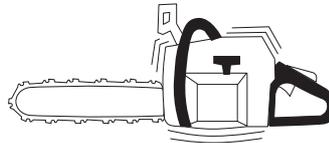
Kontrollieren, ob die Antivibrationselemente zwischen Motoreinheit und Handgriffeinheit fest verankert sind.
