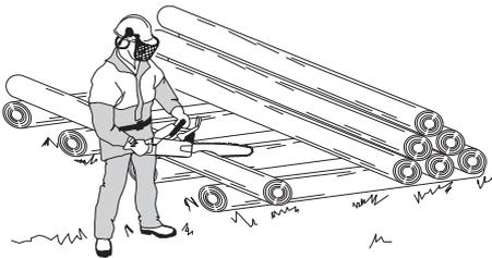
**Der Stamm liegt auf dem Erdboden.** Es besteht keine Gefahr, dass die Sägekette festklemmt oder der Baumstamm bricht. Es besteht jedoch die Gefahr, dass die Sägekette nach dem Durchsägen den Erdboden berührt.
