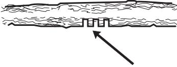
Fortfahren und tiefer sägen, bis sich die Spannung und Verklammerung des Baums/Astes löst.
