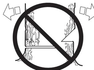
Wenn Kerb- und Fällschnitt ausgeführt sind, soll der Baum von selbst oder mit Hilfe von Fällkeil oder Fällheber fallen.
