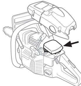
Eine gründlichere Reinigung erfolgt durch Auswaschen des Filters in Seifenwasser.
