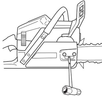
Die Kette ist richtig gespannt, wenn sie an der Schienenunterseite nicht durchhängt und noch leicht von Hand durchgezogen werden kann. Die Schienenmuttern mit dem Kombischlüssel festschrauben.
