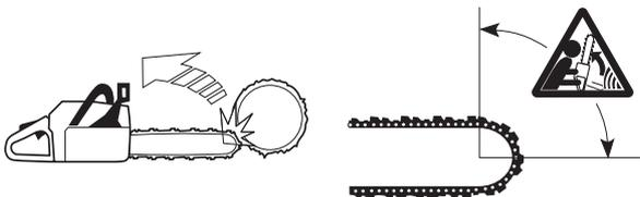
Ein Rückschlag ist immer in Richtung der Führungsschiene gerichtet. Am häufigsten erfolgt der Stoß von Motorsäge und Führungsschiene nach oben und nach hinten zum Anwender. Rückschläge erfolgen aber auch in andere Richtungen, je nachdem in welcher Stellung sich die Motorsäge in dem Augenblick befindet, in dem der Rückschlagbereich mit einem Gegenstand in Berührung kommt.
