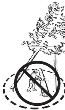
Am sichersten ist die Benutzung einer Winde.
