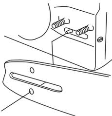
Das Rad nach unten drehen (+), um die Kette zu spannen. Die Kette sollte so gespannt werden, dass sie von der Schienenunterseite nicht durchhängt. Siehe die Anweisungen unter der Überschrift Spannen der Sägekette.
