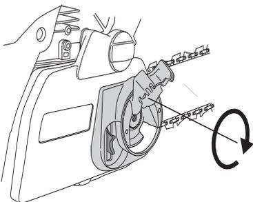
An einer neuen Kette muss die Kettenspannung oft kontrolliert werden, bis die Kette eingefahren ist. Die Kettenspannung regelmäßig prüfen. Mit einer richtig gespannten Kette wird eine gute Schnittleistung und eine lange Lebensdauer erzielt.
