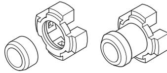
Kontrollieren, ob die Vibrationsdämpfer unbeschädigt und fest verankert sind.
