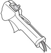
Den Motor starten und kontrollieren, ob der Motor stoppt, wenn der Stopschalter in Stoppstellung geführt wird.
