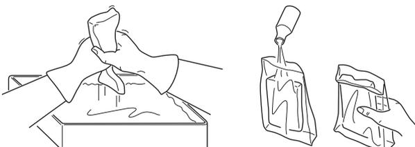
Ein Luftfilter, der längere Zeit verwendet wurde, wird nie vollkommen sauber. Der Luftfilter ist daher in regelmäßigen Abständen auszuwechseln. **Beschädigte Filter sind immer auszuwechseln.**
