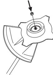
Bei der Montage die Mutter entgegen der Rotationsrichtung der Schneidausrüstung anziehen. Bei der Demontage die Mutter in der Rotationsrichtung der Schneidausrüstung lösen. (ACHTUNG! Die Mutter hat ein Linksgewinde.) Die Mutter mit dem Schlüssel für die Klingennutter anziehen.
