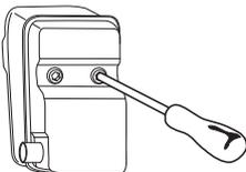
Ist der Schalldämpfer Ihres Gerätes mit einem Funkenfangnetz versehen, muss dieses regelmäßig gereinigt werden. Ein verstopftes Netz verursacht ein Heißlaufen des Motors mit schweren Motorschäden als Folge.
