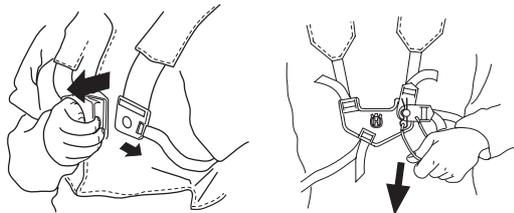
Kontrollieren, ob die Riemen des Tragegurtes richtig liegen. Wenn Tragegurt und Gerät angepasst sind, kontrollieren, ob der Schnellverschluss des Tragegurtes funktioniert.
