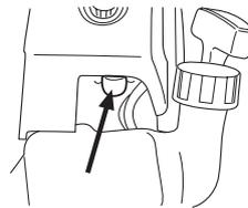
**Choke:** Den Chokehebel in Choke-Lage führen.
