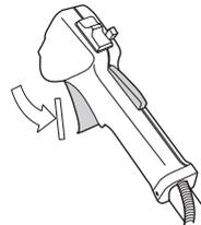
Die Gashebelsperre eindrücken und kontrollieren, ob sie in die Ausgangsstellung zurückkehrt, wenn sie losgelassen wird.
