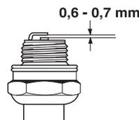
**ACHTUNG!** Stets den vom Hersteller empfohlenen Zündkerzentyp verwenden! Eine ungeeignete Zündkerze kann Kolben und Zylinder zerstören. Dafür sorgen, dass die Zündkerze eine sog. Funkentstörung hat.
