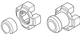
Vérifier que les éléments anti-vibrations sont entiers et solidement fixés.
