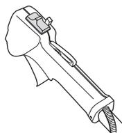
Mettre le moteur en marche et s'assurer qu'il s'arrête lorsque le bouton d'arrêt est amené en position d'arrêt.
