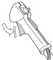
Appuyer sur le blocage de l'accélération et vérifier qu'il revient de lui-même en position initiale quand il est relâché.
