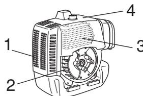
Le système de refroidissement est composé des éléments suivants:
