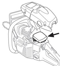
Eine gründlichere Reinigung erfolgt durch Auswaschen des Filters in Seifenwasser.
