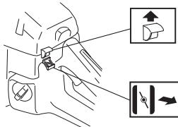
Če je naprava opremljena s črpalko goriva (A): Večkrat pritisnite na gumijasti gumb črpalke, tako da se gumb začne polniti z gorivom. Ni potrebno, da je gumb popolnoma poln.
