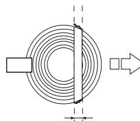
Das Brechmaß funktioniert wie ein Scharnier, das die Richtung des fallenden Baumstamms bestimmt.
