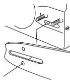
Die Kette durch Drehen der Kettenspannschraube im Uhrzeigersinn (einen Kombischlüssel verwenden) spannen. Die Kette soll gespannt werden, bis sie auf der Schienenunderseite nicht mehr durchhängt. Siehe die Anweisungen unter der Überschrift Spannen der Sägekette.
