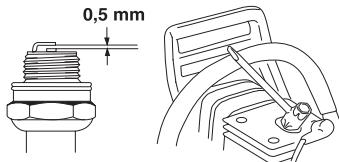
Hinweis! Stets den vom Hersteller empfohlenen Zündkerzentyp verwenden! Eine ungeeignete Zündkerze kann Kolben und Zylinder zerstören. Dafür sorgen, dass die Zündkerze eine sog. Funkentstörung hat.
