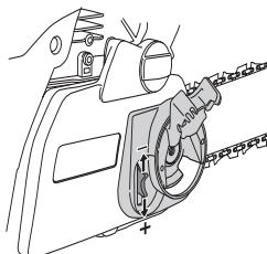
Die Kette ist korrekt gespannt, wenn sie von der Schienenunterseite nicht durchhängt, aber noch problemlos von Hand gedreht werden kann. Die Schienenspitze nach oben halten und die Schienenspülung durch Drehen des Knaufs im Uhrzeigersinn anziehen.
