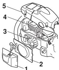
Hladilni sistem očistite s krtačo enkrat tedensko, v zahtevnih pogojih dela pa tudi pogosteje. Umazan ali zamašen hladilni sistem povzroča pregrejanje stroja, to pa poškoduje bat in cilinder.
