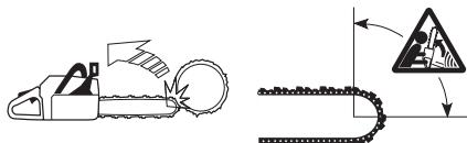
Žaganje s spodnjim robom meča, to se pravi od zgoraj navzdol, se imenuje žaganje na vlek. V tem primeru žago vleče proti deblu, njeno težo pa nosi spodnji rob meča. Ta način žaganja omogoča uporabniku boljši nadzor žage in polozaja obojnega območja meča.
