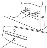
Das Rad nach unten drehen (+), um die Kette zu spannen. Die Kette sollte so gespannt werden, dass sie von der Schienenunterseite nicht durchhängt. Siehe die
