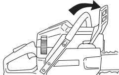
**Zündanlage; Choke:** Choker in Chokestellung bringen. Der Stoppschalter muss dabei automatisch in Startstellung wechseln.
