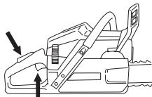
Hinweis! Die Kettenbremse rückstellen, indem der Handschutz zum Handgriffbügel geführt wird. Damit ist die Motorsäge bereit zur Anwendung.
