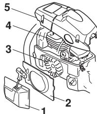
Das Kühlsystem einmal pro Woche mit einer Bürste reinigen, bei schwierigen Verhältnissen öfter. Eine Verschmutzung oder Verstopfung des Kühlsystems führt zur Überhitzung des Gerätes, die Schäden an Zylinder und Kolben zur Folge haben kann.
