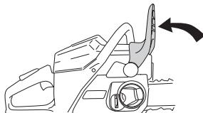
Knauf und Kupplungsdeckel (Kettenbremse) entfernen. Transportring abnehmen.
