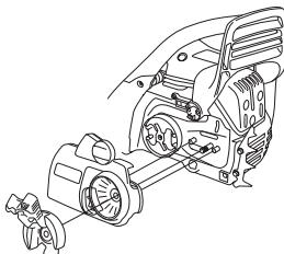
Nataknite meč na vijaka, tako da je v skrajnem zadnjem položaju. Nadenite verigo na pogonski zobnik in v žleb meča. Začnite na zgornjem robu meča.
