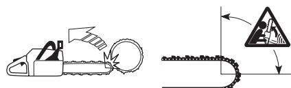
Das Sägen mit der Unterseite der Führungsschiene, d.h. von der Oberseite des Baumstammes nach unten, wird als Sägen mit ziehender Kette bezeichnet. Die Motorsäge wird zum Baumstamm hingezogen und die Vorderkante des Motorsägenkörpers fungiert als natürliche Stütze am Stamm. Beim Sägen mit ziehender Kette hat der Anwender eine bessere
