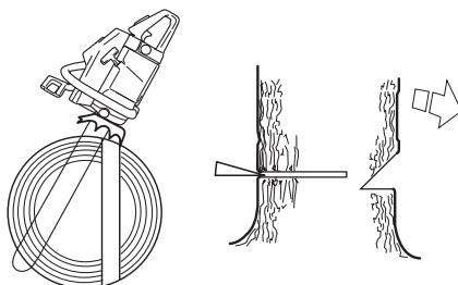
Der Fällschnitt soll parallel zur Kerbschnitlinie abschließen, so dass der Abstand zwischen beiden Schnitten mindestens 1/10 des Stammdurchmessers beträgt. Der nicht durchgesägte Teil des Stamm wird als Brechmaß bezeichnet.
