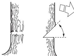
Der Schnittpunkt der beiden Schnitte wird als Kerbschnitlinie bezeichnet. Die Kerbschnitlinie soll exakt horizontal verlaufen und gleichzeitig einen rechten Winkel (90°) zur Fallrichtung bilden.
