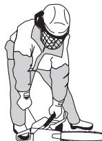
Takoj ko motor poskuša vžgati, potisnite ročico čoka navznoter, nato pa nadaljujte s poskusi, dokler motor ne vžge. Ko motor vžge, hitro dodajte polni plin; zagonski plin se samodejno izklopi.
