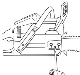
Die Kette ist richtig gespannt, wenn sie an der Schienenunderseite nicht durchhängt und noch leicht von Hand durchgezogen werden kann. Die Schienenspitze anheben und dabei gleichzeitig die Schienennutern mit dem Kombischlüssel festschrauben.
