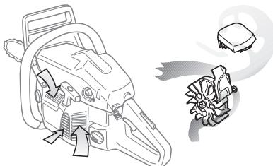
**POMEMBNO!** Učinkovitost centrifugalnega čiščenja je odvisna od rednega vzdrževanja in nege. Očistite dovod zraka v zaganjalnik, krila ventilatorja, prostor okrog ventilatorja, dovodno cev in komoro uplinjača.
