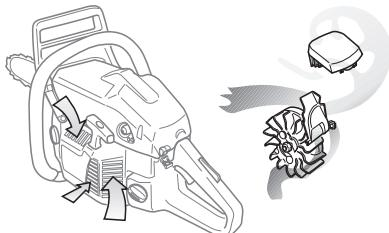
**WICHTIG!** Um die Funktion der Zentrifugalreinigung aufrecht zu erhalten, muss diese regelmäßig gewartet und gepflegt werden. Den Lufteinlass der Startvorrichtung, die Gebläseflügel des Schwungrads, den Raum um das Schwungrad, das Ansaugrohr und den Vergaserraum reinigen.
