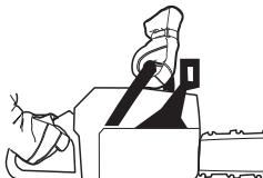
Poženite motor s polnim plinom in sprožite zavoro verige, tako da z levim zaprestjem odsunete ščitnik odsunka. Pri tem ne spustite sprednjega ročaja. **Veriga se mora v trenutku ustaviti.**
