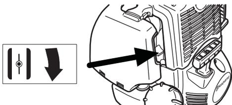
**Pompe à carburant:** Appuyer sur la poche en caoutchouc de la pompe à carburant plusieurs fois jusqu'à ce que le carburant commence à remplir la poche. Il n'est pas nécessaire de remplir la poche complètement.
