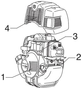
Le système de refroidissement est composé des éléments suivants:
