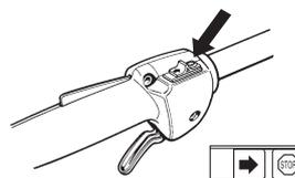
Mettre le moteur en marche et s'assurer qu'il s'arrête lorsque le bouton d'arrêt est amené en position d'arrêt.
