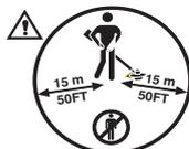
Les machines équipées de lames d'éclaircissage ou de disques à herbe peuvent être projetées violemment d'un côté quand la lame heurte un objet fixe. Ce phénomène est appelé rebond. La lame peut amputer un bras ou une jambe. Veiller à ce que les personnes et les animaux soient toujours à au moins 15 mètres de la machine.
