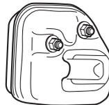
Le risque d'incendie est important dans les pays au climat chaud et sec. C'est pourquoi nous avons équipé certains silencieux de grilles antiflamme. Vérifier si le silencieux de la machine est muni d'un tel dispositif.
