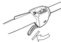
Appuyer sur le blocage de l'accélération et vérifier qu'il revient de lui-même en position initiale quand il est relâché.
