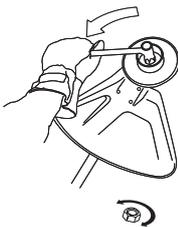
L'usure du verrouillage nylon du contre-écrou ne doit pas être telle qu'il peut se visser à l'aide des doigts. Le verrouillage doit résister à 1,5 Nm au moins. Remplacer le contre-écrou après une dizaine de serrages.
