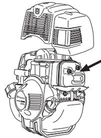
Le silencieux de la machine est équipé d'une grille antiflamme qui doit être nettoyée régulièrement. Une grille bouchée entraîne une surchauffe du moteur pouvant provoquer des dommages graves.
