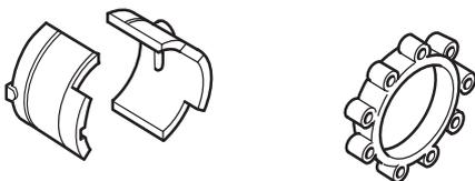
Vérifier régulièrement l'état des éléments afin de détecter fissures et déformations. Vérifier que les éléments anti-vibrations sont entiers et solidement fixés.
