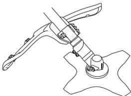
S'assurer que la protection est intacte et qu'elle ne présente pas de fissures. Remplacer la protection si elle a subi des coups ou si elle présente des fissures.
