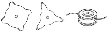
Maintenir les dents de la lame correctement affûtées! Suivre nos instructions et utiliser le calibre d'affûtage recommandé. Une lame mal affûtée ou endommagée augmente les risques d'accident.
