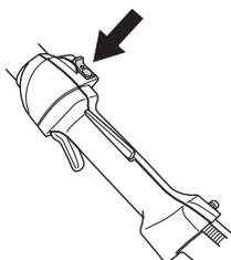
**REMARQUE!** L'interrupteur d'arrêt se remet automatiquement en position de démarrage. Toujours retirer le chapeau de bougie de la bougie lors du montage, contrôle et/ou entretien, afin d'éviter tout démarrage accidentel.
