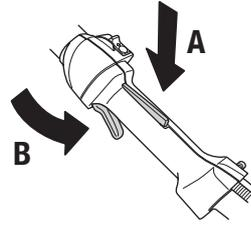
Vérifier d'abord que la commande de l'accélération est bloquée en position de ralenti quand le blocage de l'accélération est en position initiale.
