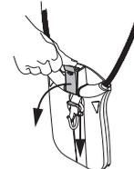
S'assurer du bon positionnement des bretelles du harnais. Quand le harnais et la machine sont ajustés, contrôler le bon fonctionnement du dispositif de libération rapide du harnais.
