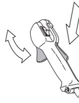
Voir le chapitre Démarrage. Démarrer la machine et donner les pleins gaz. Relâcher l'accélérateur et s'assurer que l'équipement de coupe s'arrête et qu'il reste immobile. Si l'équipement de coupe tourne lorsque l'accélérateur est au régime de ralenti, contrôler le réglage du ralenti du carburateur. Voir le chapitre Entretien.
