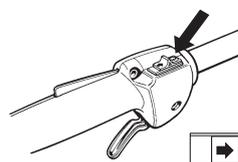
Den Motor starten und kontrollieren, ob der Motor stoppt, wenn der Stoppschalter in Stoppstellung geführt wird.
