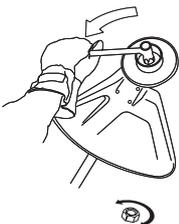
Die Nylonsicherung der Mutter darf nicht so abgenutzt sein, dass sie sich von Hand schrauben lässt. Die Sicherung soll mindestens 1,5 Nm halten. Nachdem sie ca. 10 Mal aufgeschraubt worden ist, ist die Mutter auszutauschen.
