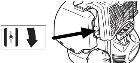
**Kraftstoffpumpe:** Mehrmals auf die Gummiblase der Kraftstoffpumpe drücken, bis diese sich mit Kraftstoff zu füllen beginnt. Die Blase braucht nicht ganz gefüllt zu werden.
