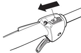
**Choke:** Den Chokehebel in Choke-Lage führen.
