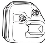
In Ländern mit warmem, trockenem Klima besteht erhöhte Brandgefahr. Bestimmte Schalldämpfer haben wir deshalb mit einem sog. Funken-fängernetz ausgestattet. Kontrollieren Sie, ob der Schalldämpfer Ihres Gerätes ein solches Netz hat.
