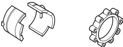
Die Antivibrationselemente regelmäßig auf Risse und Verformungen überprüfen. Kontrollieren, ob die Vibrationsdämpfer unbeschädigt und fest verankert sind.
