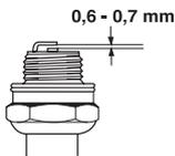
**ACHTUNG!** Stets den vom Hersteller empfohlenen Zündkerzentyp verwenden! Eine ungeeignete Zündkerze kann Kolben und Zylinder zerstören. Dafür sorgen, dass die Zündkerze eine sog. Funkentstörung hat.
