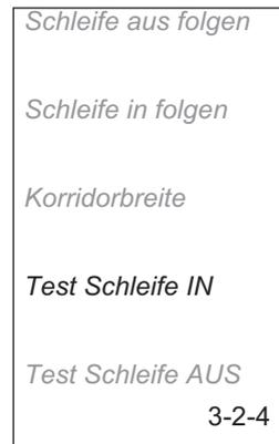
Bei Auswahl dieser Funktion folgt der Mäher direkt dem Begrenzungskabel, S-Kabel 1 oder S-Kabel 2 zur Ladestation – je nachdem, welches Kabel er zuerst findet. Wenn eine Passage vorhanden ist, die vom Mäher nicht durchquert werden kann, wurde der Wert für die *Korridorbreite* zu hoch eingestellt. Wenn für den Mäher *Test Schleife IN* aktiviert ist, bewegt sich das Gerät im maximalen Abstand zum Kabel, den die gewählte *Korridorbreite* zulässt.
