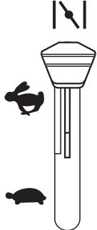
(RU) Холодный двигатель: приведите регулятор газа в крайнее положение choke (||).
