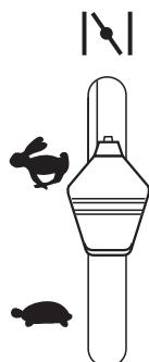
(RU) Разогретый двигатель: переместите регулятор газа на пол-пути в положение полного газа “充满了”.
