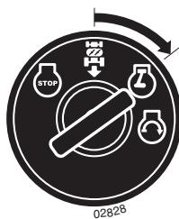
Положение двигателя "ON" (обычная работа)
