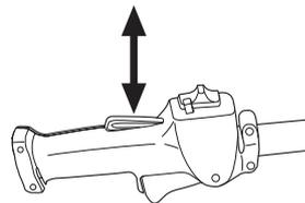
Kontrollieren, ob Gashebel und Gashebelsperre mit dem dazugehörigen Rückzugfedersystem leicht funktionieren.
