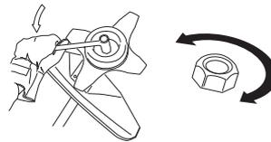
Die Nylonsicherung der Mutter darf nicht so abgenutzt sein, dass sie sich von Hand schrauben lässt. Die Sicherung soll mindestens 1,5 Nm halten. Nachdem sie ca. 10 Mal aufgeschraubt worden ist, ist die Mutter auszutauschen.
