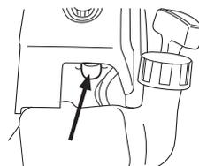
**Choke:** Den Chokehebel in Choke-Lage führen.
