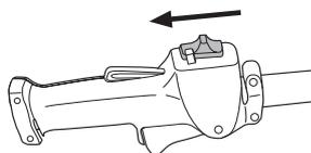
**Kraftstoffpumpe:** Mehrmals auf die Gummiblase der Kraftstoffpumpe drücken, bis diese sich mit Kraftstoff zu füllen beginnt. Die Blase braucht nicht ganz gefüllt zu werden.
