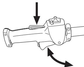
Siehe die Anweisungen unter der Überschrift Start. Gerät starten und Vollgas geben. Den Gashebel loslassen und kontrollieren, ob die Schneidausrüstung völlig zum Stillstand kommt. Wenn die Schneidausrüstung rotiert, während sich der Gashebel in Leerlaufstellung befindet, ist die Leerlaufeinstellung des Vergasers zu kontrollieren. Siehe die Anweisungen unter der Überschrift Wartung.
