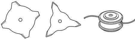
Die Schneidzähne der Klinge sollen stets korrekt und gut geschärft sein! Befolgen Sie unsere Anleitung und verwenden Sie die empfohlene Schärflöhre. Eine falsch geschärfte oder beschädigte Klinge erhöht die Unfallgefahr.
