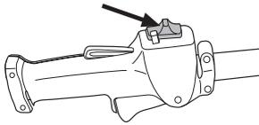
Den Motor starten und kontrollieren, ob der Motor stoppt, wenn der Stopschalter in Stopstellung geführt wird.
