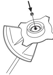
Bei der Montage die Mutter entgegen der Rotationsrichtung der Schneidausrüstung anziehen. Bei der Demontage die Mutter in der Rotationsrichtung der Schneidausrüstung lösen. (ACHTUNG! Die Mutter hat ein Linksgewinde.) Die Mutter mit dem Schlüssel für die Klingenmutter anziehen.
