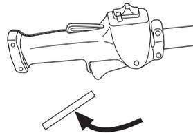
Die Gashebelsperre eindrücken und kontrollieren, ob sie in die Ausgangsstellung zurückkehrt, wenn sie losgelassen wird.
