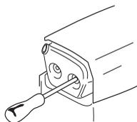
Certains silencieux sont munis d'une grille antiflamme. Cette grille doit être nettoyée une fois par semaine si la machine en est équipée. Utiliser de préférence une brosse en acier. Un pare-étincelles colmaté risque de causer la surchauffe du moteur et de provoquer de sérieuses avaries du moteur.
