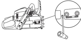
La chaîne est tendue correctement quand elle ne pend plus sous le guide et peut être avancée à la main sans difficulté. Serrer les écrous du guide à l'aide de la clé universelle tout en maintenant levé le pignon du guide.
