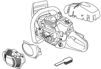
Nettoyer le système de refroidissement avec une brosse une fois par semaine, voire plus souvent dans des conditions difficiles. Un système de refroidissement sale ou colmaté provoque la surchauffe de la machine, endommageant le cylindre et le piston.
