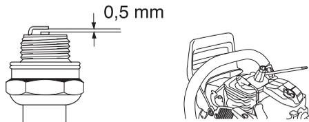
Remarque! Toujours utiliser le type de bougie recommandé! Une bougie incorrecte peut endommager le piston/le cylindre. S'assurer que la bougie est dotée d'un antiparasites.
