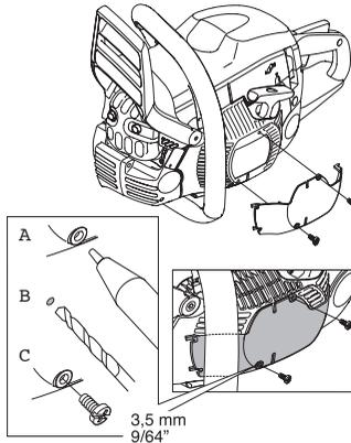
**REMARQUE!** Si le kit spécial hiver est utilisé ou si des mesures sont prises pour augmenter la température, il convient de revenir au réglage normal, dans la mesure où la machine est alors utilisée dans des conditions de températures normales. Sinon il y a risque de surchauffe avec pour conséquence de graves dommages au moteur.
