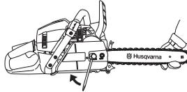
La tension d'une chaîne neuve doit être vérifiée fréquemment pendant son rodage. Vérifier régulièrement la tension. Une tension correcte est synonyme de bonne capacité de coupe et de longue durée de vie.
