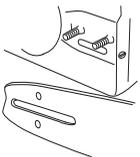
Tendre la chaîne en tournant la vis du tendeur de chaîne vers la droite à l'aide de la clé universelle. Tendre la chaîne jusqu'à ce qu'elle ne pende plus sous le guide.
