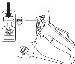
Le moteur est arrêté en poussant l'interrupteur d'arrêt en position d'arrêt.
