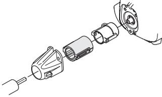
Die Antivibrationselemente regelmäßig auf Risse und Verformungen überprüfen. Kontrollieren, ob die Vibrationsdämpfer unbeschädigt und fest verankert sind.
