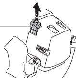
**Kraftstoffpumpe:** Mehrmals auf die Gummiblase der Kraftstoffpumpe drücken, bis diese sich mit Kraftstoff zu
