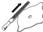
Die korrekte Schrängung der Sägeklinge beibehalten! Befolgen Sie unsere Anweisungen und verwenden Sie das empfohlene Schrängwerkzeug. Eine falsch geschränkte Sägeklinge erhöht das Risiko für das Festfahren und für Rückschläge sowie Schäden an der Klinge.
