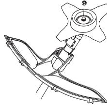
Bei der Montage die Mutter entgegen der Rotationsrichtung der Schneidausrüstung anziehen. Bei der Demontage die Mutter in der Rotationsrichtung der Schneidausrüstung lösen. (ACHTUNG! Die Mutter hat ein Linksgewinde.) Die Mutter mit dem Schlüssel für die Klingennutter anziehen.
