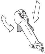
Siehe die Anweisungen unter der Überschrift Start. Gerät starten und Vollgas geben. Den Gashebel loslassen und kontrollieren, ob die Schneidausrüstung völlig zum Stillstand kommt. Wenn die Schneidausrüstung rotiert, während sich der Gashebel in Leerlaufstellung befindet, ist die Leerlaufeinstellung des Vergasers zu kontrollieren. Siehe die Anweisungen unter der Überschrift Wartung.
