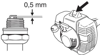
**ACHTUNG!** Stets den vom Hersteller empfohlenen Zündkerzentyp verwenden! Eine ungeeignete Zündkerze kann Kolben und Zylinder zerstören.
