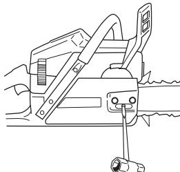
Ketjun kireys on oikea, kun se ei roiku löysällä terälevyn alapuolella ja liikkuu kevyesti käsissä pyöritettäessä. Kiristää terämitterit yhdistelmävaimella pitäen samalla terälevyn kärkeä ylhäällä.
