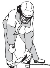
Trykk inn choken umiddelbart når motoren terner og gjør flere startforsøk til motoren starter. Når motoren starter gir du raskt full gass, og startgassen koples ut automatisk.
