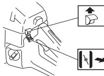
**Brændstofpumpe:** Hvis maskinen er forsynet med brændstofpumpe (A): Tryk flere gange på brændstofpumpens gummiblære, indtil blæren fyldes med brændstof. Det er ikke nødvendigt at fynde blæren helt.
