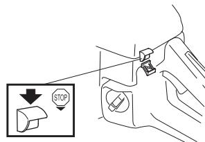
Motoren standses ved at anbringe stopknappen i stopstilling.
