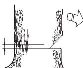
Placer barkstøtten (hvis den er monteret) bag brudpunktet. Sav med fuld gas, og før savkæden/sværdet langsomt ind i træet. Vær opmærksom på, om træet bevæger sig i modsat retning i forhold til den valgte faldretning. Sæt en fældekile i eller et brækjern i fældesnittet, så snart snitdybden tillader det.
