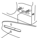
Spænd kæden ved at bruge kombinøglen til at skru kædestammerskruen med uret. Kæden skal strammes til, så den ikke hænger slapt ned på sværrets underside. Se anvisningerne i afsnittet Stramning af savkæden.
