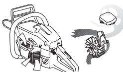
VIGTIGT! For at bevare centrifugalrensningens funktion skal man udføre kontinuerlig pleje og vedligeholdelse. Rens startaggregatets luftindtag, svinghjulets ventilatorflanger, området omkring svinghjulet, indugsningsrøret og karburatorrummet.
