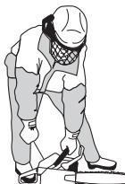
Tryck in chokereglaget omedelbart när motorn tänds och gör förynda startförsök tills motorn startar. När motorn startar, ge snabb fullgas och startgasen kopplas automatiskt ur.
