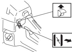
**Brennstoffpumpe:** Hvis maskinen har drivstoffpumpe (A): Trykk på brennstoffpumpens gummiblaire gjentatte ganger til brennstoff begynner å fylle blæren. Blæren behøver ikke å fylles helt.
