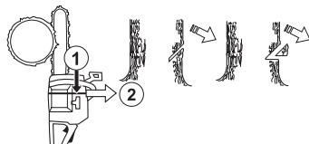
Retningssnitdybden skal være  $\frac{1}{4}$  af stammens diameter, og vinklen mellem over- og undersnit skal være mindst  $45^\circ$ .
