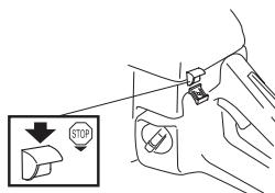
Motorn stannas genom att skjuta stoppkontakten till stoppläge.
