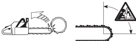
Kast färdas alltid i svärdsplanets riktning. Vanligast är att motorsåg och svärd kastas uppåt och bakåt mot användaren. Dock förekommer andra kastriktningsar beroende på vilket läge motorsågen har i det ögonblick svärdets kastrisksektor kommer i kontakt med ett föremål.
