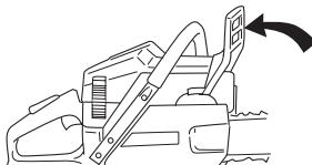
Ruuvaa terämitterit irti ja irrota kytkinkotelo (ketjupuoli). Poista kuljetussuoja (A).
