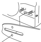
Kiristää ketju kiertämällä ketjun kiristysruuvia yhdistelmävaimella myötäpäivään. Ketjua on kiristettävä sen verran, ettei se roiku löysällä terälevyn alapuolella. Katso otsikon Teräketjun kiristäminen alla annetut ohjeet.
