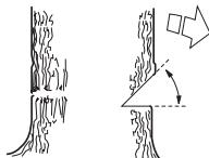
Ylä- ja alasahauksen kohtamispistettä kutsutaan kaatolovilinjaksi. Kaatolovilinjan on oltava tarkasti vaakasuorassa ja muodostettava samalla suora kulma ( $90^\circ$ ) valittuun kaatosuuntaan nähden.
