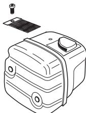
Lyddemperen er utformet for å dempe lydnivået og for å lede avgassene bort fra brukeren. Avgassene er varme og kan inneholde gnister som kan forårsake brann hvis gassene rettes mot et tørt og brennbart materiale.
