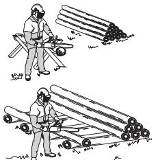
**Stokken ligger på bakken.** Det er ingen fare for at sagkjedet skal klemmes fast eller at sagobjektet skal splinters. Det er imidlertid stor fare for at sagkjedet treffer bakken etter gjennomsaging.
