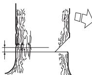
Sätt i barkstödet (om något är påmonterat) bakom brytmånen. Såga med fullgas och för sågkedjan/svärden sakta in i trädet. Var observant på om trädet rör sig i motsatt riktning till vald fallriktning. Sätt i en fällkil eller ett brytjärn i fällskäret så snart skärdjupet tillåter.
