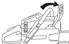
**Tenning; choke:** Still chokehendelen i chokesetting. Stoppbryteren skal da stilles automatisk på startposisjon.
