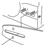
Stram kjedet ved å skru kjedestammerskruen med klokken med kombinøkkelen. Kjedet skal strammes til det ikke henger ned på undersiden av sverdet. Se anvisninger under overskriften Stramming av sagkjedet.
