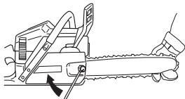
På en ny kæde skal kædestramningen kontrolleres ofte, indtil kæden er kørt til. Kontrollér kædestramningen regelmæssigt. Korrekt kæde betyder god skærekapacitet og lang levetid.
