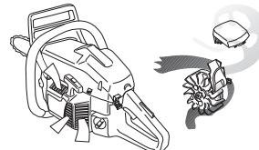
TÄRKEÄÄ! Keskipakoispuhdistuksen tehon säilyttämiseksi on huolehdittava säännöllisestä huollossa. Puhdista käynnistimen ilmanottoaukot, vauhtipyörän tuuletinsiivet, vauhtipyörän ympäristö, imuputki ja kaasutintila.
