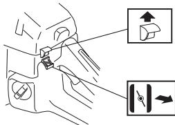
**Bränslepump:** Om maskinen är utrustad med en bränslepump (A): Tryck på bränslepumpens gummiblåsa uppredade gånger tills bränsle börjar fylla blåsan. Blåsan behöver ej fyllas helt.
