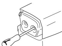
Visse lyddæmpere er udstyret med et specielt gnistfangernet. Hvis din maskine er udstyret med en sådan lyddæmper, bør nettet rengøres en gang om ugen. Dette gøres bedst med en stålborste. Et tilstoppet net medfører, at motoren kører varm med alvorlig motorskade til følge.
