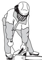
Tryk chokeren ind, så snart motoren tænder, og gør nye forsøg, indtil motoren starter. Når motoren starter, gives hurtig fuld gas, og startgassen kobles automatisk fra.
