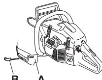
Disse reduserer kjøleluften og hindrer at større mengder snø suges inn i forgasserrommet.
