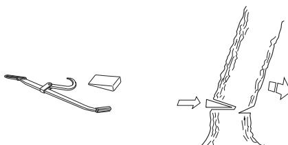
Vi rekommenderar användande av en svärdslängd som överstiger trädets stamdiameter, så att fäll- och riktskär kan utföras med ett s.k. "enkelt sågsnitt". Se anvisningar under rubrik Tekniska data angående vilka svärdslängder som rekommenderas för din motorsågsmodell.
