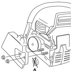
Montér sværdet over sværboltene. Placér sværdet i dets bagerste stilling. Placér kæden over kædedrivhjulet og i sværdsportet. Begynd på sværrets overside.
