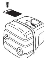
Lyddæmperen er beregnet til at dæmpe lydniveauet og til at lede udstdødningsgasserne væk fra brugeren. Udstdødningsgasserne er varme og kan indeholde gnister, som kan forårsage brand, hvis udstdødningsgasserne rettes mod et tørt og brændbart materiale.
