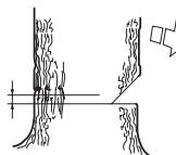
Sett i barkstøtten (hvis en slik er montert) bak brytekanten. Sag med full gass og for sagkjedet/sverdet sakta inn i treet. Vær på vakt mot at treet beveger seg i motsatt retning av det som er valgt som fallretning. Sett i en fellekile eller et brytejern i hovedskåret så snart skjæredybden tillater det.
