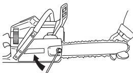
Uuden ketjun kireys on tarkastettava usein ketjun sisäänajon aikana. Tarkasta ketjun kireys säännöllisesti. Oikein kiristetty ketju takaa hyvän leikkutehon ja pitkän kestoisen.
