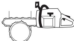
Käytössä on menetelmiä, joilla voidaan kaataa terälevyn pituutta paksumpia puita. Näitä menetelmiä käytettäessä on erittäin suuri vaara, että terälevyn takapotkusektori osuu johonkin.
