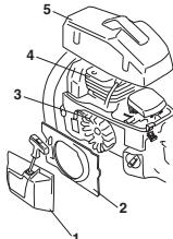
Rens kølesystemet med en børste en gang om ugen, under støvfyldte forhold oftere. Et snavset eller tilstoppet kølesystem medfører overopvarmning af maskinen med skader på cylinderen og stemplet til følge.
