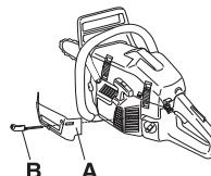
Disse reducerer køleluften og forhindrer, at større mængder sne kan suges ind i karburatorrummet.
