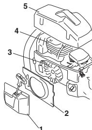
Rengjør kjølesystemet med en børste en gang i uken, ved vanskelige forhold oftere. Et tilsmusset eller tett kjølesystem fører til at maskinen overopphetes, noe som forårsaker skader på sylinder og stempel.
