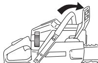
**Tænding; choker:** Sæt chokeren i chokerstilling. Stopkontakten indstilles herefter automatisk til startposition.
