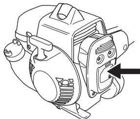
Nekateri modeli dušilcev so opremljeni s posebno mrežico za gašenje isker. Če je vaš stroj opremljen s dušilcem tega tipa, morate mrežico enkrat tedensko očistiti. V ta namen uporabljajte žično krtačo. Na dušilih brez katalizatorja je mrežico za lovljenje isker priporočljivo očistiti in po potrebi zamenjati enkrat na teden. Na dušilih s katalizatorjem preglejte in očistite mrežico za lovljenje isker enkrat na mesec. **Če je mrežica poškodovana, jo zamenjate.** Če je
