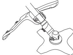
Den Schutz auf Schäden und Risse kontrollieren. Den Schutz austauschen, wenn er Schlägen ausgesetzt war oder Risse aufweist.
