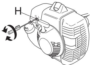
Upoštevajte, da je treba obremeniti motor med nastavljanjem brizgalne šobe H za velike hitrosti. Zato je treba namestiti rezalno glavo T35 (2.7 – milimetrski vrvi), preden nastavite brizgalno šobo za velike hitrosti. Dolžina kabla mora biti standardna, n.pr. takšna, da ustreza rezilu na ščitniku obrezovalnika.
