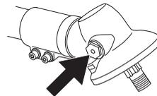
Das Schmiermittel im Getriebegehäuse braucht normalerweise nur bei evtl. Reparaturen gewechselt zu werden.
