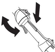
Glej poglavje pod naslovom Vžig. Vžgite stroj in mu dajte polni plin. Izpustite plinsko ročico in se prepričajte, da se rezilni priključek ustavi in obmiruje. Če se rezilni priključek vrtil, ko je plinska ročica v legi prostega teka, preglejte nastavitve uplinjača v prosti legi. Glejte navodila v poglavju Vzdrževanje.
