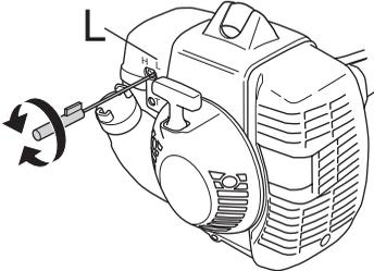
**ACHTUNG!** Wenn die Schneidausrüstung sich im Leerlauf dreht, ist die T-Schraube gegen den Uhrzeigersinn zu drehen, bis die Schneidausrüstung stehenbleibt.
