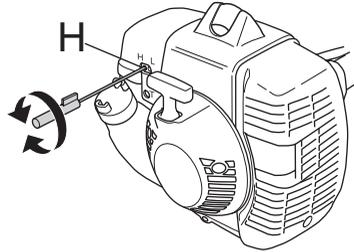
Bitte beachten, dass der Motor bei der Einstellung der Hochdrehzahldüse H belastet sein soll. Daher den Trimmerkopf T35 (2,7-mm-Faden) vor dem Einstellen der Hochdrehzahldüse montieren. Der Faden soll die Standardlänge haben, d. h. bis zum Messer am Trimmerschutz.
