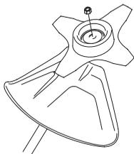
Bei der Montage die Mutter entgegen der Rotationsrichtung der Schneidausrüstung anziehen. Bei der Demontage die Mutter in der Rotationsrichtung der Schneidausrüstung lösen. (ACHTUNG! Die Mutter hat ein Linksgewinde.) Die Mutter mit dem Hülsenschlüssel anziehen.
