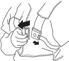
Kontrollieren, ob die Riemen des Tragegurtes richtig liegen. Wenn Tragegurt und Gerät angepasst sind, kontrollieren, ob der Schnellverschluss des Tragegurtes funktioniert.
