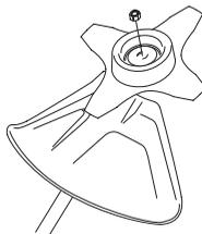
Pri montaži priključkov zategnite matico v nasprotni smeri rotacije rezilnih priključkov. Pri demontaži rezilnih priključkov zrahljate matico v smeri vrtenja. (POZOR! Matica ima levi navoj.) Zategnite matico s ključem.
