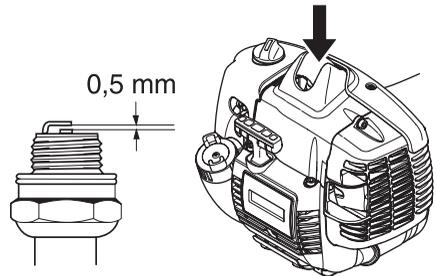
**ACHTUNG!** Stets den vom Hersteller empfohlenen Zündkerzentyp verwenden! Eine ungeeignete Zündkerze kann Kolben und Zylinder zerstören.
