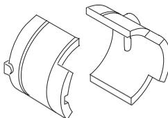
Redno preverjajte stanje elementov za dušenje vibracij. Bodite pozorni na morebitne razpoke in druge deformacije. Prepričajte se, če so dušilni elementi celi in dobro pritrjeni.
