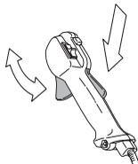
Glej poglavje pod naslovom Vžig. Vžgite stroj in mu dajte polni plin. Izpustite plinsko ročico in se prepričajte, da se rezilni priključek ustavi in obrne. Če se rezilni priključek vrti, ko je
