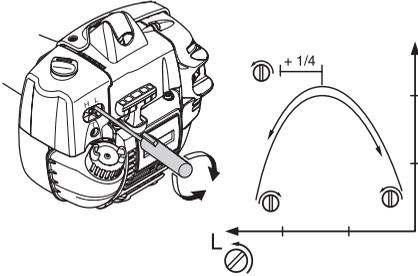
**ACHTUNG!** Wenn die Schneidausrüstung sich im Leerlauf dreht, ist die T-Schraube gegen den Uhrzeigersinn zu drehen, bis die Schneidausrüstung stehenbleibt.
