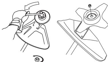
Matični nylonski zatič ne sme biti tako izrabljen, da ga je mogoče odvit s prsti. Navoj mora zdržati najmanj 1,5 Nm. Matico po desetkratni uporabi zamenjajte.
