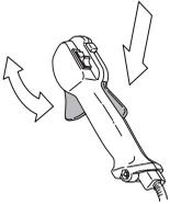
Siehe die Anweisungen unter der Überschrift Start. Gerät starten und Vollgas geben. Den Gashebel loslassen und kontrollieren, ob die Schneidausrüstung völlig zum Stillstand kommt. Wenn die Schneidausrüstung rotiert, während sich der Gashebel in Leerlaufstellung befindet, ist die Leerlaufstellung des Vergasers zu kontrollieren. Siehe die Anweisungen unter der Überschrift Wartung.
