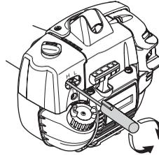
Vollgas geben und die Hochdrehzahl Düse H sehr langsam im Uhrzeigersinn drehen, bis die Motorgeschwindigkeit abnimmt. Anschließend die Hochdrehzahl Düse H sehr langsam gegen den Uhrzeigersinn drehen, bis der Motor ungleichmäßig läuft. Danach die Hochdrehzahl Düse H langsam geringfügig im Uhrzeigersinn drehen, bis der Motor gleichmäßig läuft.
