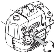
Dodajte polni plin in zelo počasi obračajte šobo za visoko število vrtljajev H v smeri urinega kazalca, dokler se hitrost motorja ne zmanjša. Nato zelo počasi obračajte šobo za visoko število vrtljajev H v nasprotni smeri urinega kazalca, dokler motor ne začne delovati neenakomerno. Šobo za visoko število vrtljajev H nato počasi obračajte v smeri urinega kazalca, dokler motor spet ne deluje enakomerno.
