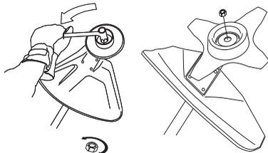
Die Nylonsicherung der Mutter darf nicht so abgenutzt sein, dass sie sich von Hand schrauben lässt. Die
