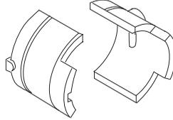
Kontroller regelmessig avvibreringselementene med tanke på materialsprekker og deformering. Kontroller at avvibreringselementene er hele og fast forankret.
