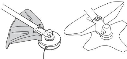
Tarkasta, että suojus on ehjä ja ettei siinä ole halkeamia. Vaihda suojus, jos siihen on kohdistunut iskuja tai siinä on halkeamia.
