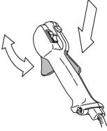
Katso otsikon Käynnistys alla annetut ohjeet. Käynnistä kone ja anna täysi kaasu. Löysää kaasuliipasin ja tarkasta, että terälaitte pysähtyy ja pysyy liikkumattomana. Jos terälaitte pyörii, kun kaasuliipasin on joutokäyntiasennossa, on kaasuttimen joutokäyntisäättö tarkastettava. Katso otsikon Kunnossapito alla annetut ohjeet.
