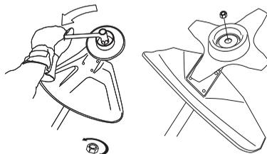
Låsemutterens nylonlåsning må ikke være så slitt at den kan skrues med fingrene. Låsningen må holde minst 1,5 Nm. Mutteren må skiftes etter at den har vært skrudd på ca. 10 ganger.
