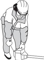
**OBS!** Ikke plasser noen del av kroppen på den markerte flaten. Berøring kan medføre brannskader på huden eller elektrisk støt dersom tennpluggheten er defekt. Bruk alltid hansker. Bruk aldri en maskin med defekt tennplugghetten.
