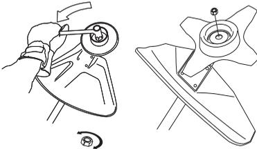
Lukitusmutterin nailonlukitus ei saa olla niin kulunut, että sitä voi ruuvata käsin. Lukituksen on kestävä vähintään 1,5 Nm. Mutteri on vaihdettava, kun se on ruuvattu kiinni noin 10 kertaa.
