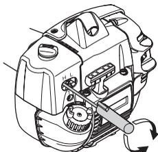
Gi full gass og vri høyturtallsmunnstykket H meget sakte med urviseren til motorhastigheten reduseres. Vri deretter høyturtallsmunnstykket H meget sakte mot urviseren til motoren går ujevnt. Høyturtallsmunnstykket H vris deretter sakte med urviseren en anelse til motoren går jevnt.
