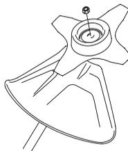
Trekk til mutteren mot skjæreutstyrets rotasjonsretning ved montering. Løsne mutteren i skjæreutstyrets rotasjonsretning ved demontering. (OBS! Mutteren er venstregjenget.) Trekk til mutteren med pipenøkkel.
