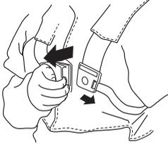
Tarkasta, että valjaiden hihnat on asetettu oikein. Kun valjaat ja kone on säädetty, tarkasta, että valjaiden pikairrotin toimii.
