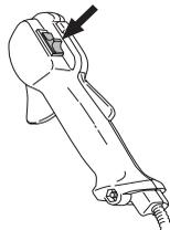
**HUOM!** Pysäytyskosketin palautuu automaattisesti käynnistysasentoon. Sen vuoksi, tahattoman käynnistyksen estämiseksi, syytystulpan suojus on aina irrotettava syytystulpasta asennuksen, tarkastuksen ja/ tai huollon ajaksi.
