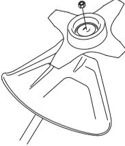
Asennettaessa, kiristä mutteri terälaitteen pyörimissuuntaa vastaan. Irrotettaessa, irrota mutteri terälaitteen pyörimissuuntaan. (HUOM! Mutterissa on vasenkätinen kierre.) Kiristä mutteri hylsyavaimella.
