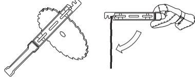
Kontroller skjærestyret med henblikk på skader og sprekkdannelse. Skadet skjærestyr må alltid skiftes.
