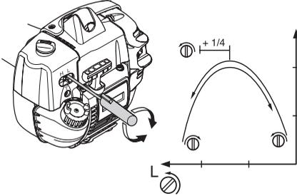
**HUOM!** Jos terälaite pyöri joutokäynnillä, T-ruuvia on kierrettävä vastapäivään, kunnes terälaite pysähtyy.
