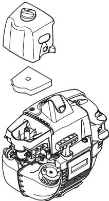
Rengjør luftfilteret etter 25 timers drift, oftere hvis maskinen brukes under forhold med usedvanlig mye støv.
