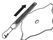
Tarkasta terälaitte vaurioiden ja halkeamien varalta. Vaurioitunut terälaitte on aina vahdettava.
