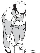
**BEMÆRK!** Anbring ikke nogen legemsdele på den markerede overflade. Kontakt kan medføre forbrændinger af huden eller elektrisk stød, hvis tændhætten er defekt. Anvend altid handsker. Anvend aldrig en maskine med defekt tændhætte.
