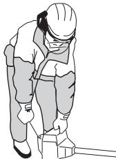
**OBS!** Ikke plasser noen del av kroppen på den markerte flaten. Berøring kan medføre brannskader på huden eller elektrisk støt dersom tennpluggen er defekt. Bruk alltid hansker. Bruk aldri en maskin med defekt tennplughette.
