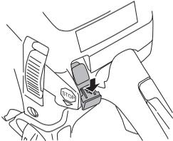
**NEZABUDNITE!** Spínač spustenia/zastavenia sa automaticky vráti do polohy chodu. Pre zamedzenie neúmyselného spustenia musí byť viečko kábla zapalovacej sviečky pri montáži, kontrole a/alebo vykonávaní údržby zo zapalovacej sviečky odstránené.
