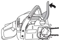
Uvoľnite kotúč napínača reťaze z vodiacej lišty a kryt spojky (brzda reťaze). Odstráňte ochranný kryt (A).
