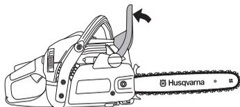
Odskrutkujte maticu lišty a odstráňte kryt spojky (brzda reťaze). Vytiahnite prepravny krúžok (A).
