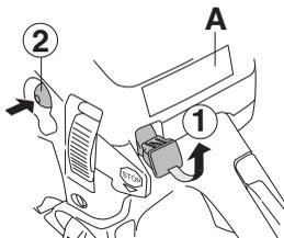
Levou rukou uchopte přední rukojeť. Pravou nohu zasaňte do zadní rukojeti a přišlápněte motorovou pilu pevně k zemi. Uchopte pravou rukou startovací rukojeť a pomalu vytáhněte startovací lanko až pocítíte odpor (v této chvíli došlo k zaskočení západek ve startovacím mechanismu) a potom silně a rychle a zatahněte, až motor naskočí (3).
