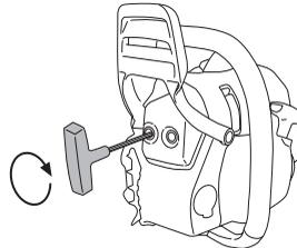
Niektoré tlmiče výfuku sú vybavené špeciálnou sieťou na zachytávanie iskiev. Ak má vaša píla tento typ tlmiča, mali by ste sieťku čistiť aspoň jedenkrát týždenne. Najlepšie sa sieťka čistí drôtenou kefov. Zanesený zachytávač spôsobí prehriatie motora a môže zapríčiniť jeho vážne poškodenie.
