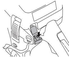
Zastavte motor stisknutím spínače spuštění/zastavení směrem dolů.
