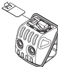
Při montáži sítky se ujistěte, že je správně vložena. V případě potřeby použijte ke vložení nebo vyjmutí sítky kombinované kleště.
