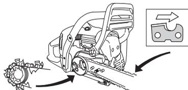
Zkontrolujte, zda břity řezacích článků směřují na horní hraně lišty dopředu.
