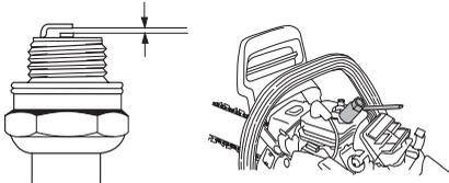
**Poznámka!** Vždy používajte odporúčaný typ zapaľovacej sviečky! Nesprávna zapaľovacia sviečka môže vážne poškodiť piest/valec. Skontrolujte, či je zapaľovacia sviečka správne nasadená.
