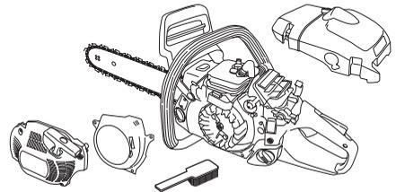
Chladicí systém je zapotřebí čistit kartáčem jednou za týden, v případě náročných podmínek ještě častěji. Znečištěný nebo ucpaný chladicí systém má za následek přehřívání zařízení, což vede k poškození válce a pístu.
