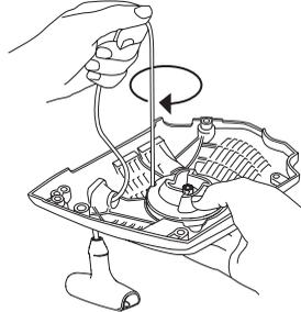
Natiahnite šnúru pomocou držadla. Odsunutím palca uvoľníte šnúru. Viď obrázok nižšie.
