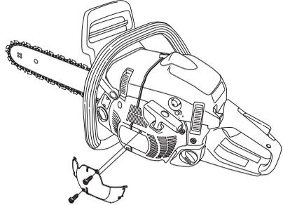
**NEZABUDNITE!** Ak ste namontovali zvláštne zariadenie na prevádzku v zime, alebo ste nejakými opatreniami zvýšili teplotu, je nutné všetky tieto opatrenia a zariadenia odstrániť, ak budete stroj používať v teplotne normálnych podmienkach. Ináč hrozí nebezpečie prehriatia, čo môže vážne poškodiť motor.
