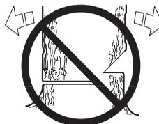
Po dokončení směrového zářezu a hlavního řezu by se strom měl začít kácet samovolně nebo pomocí dřevorubeckého klínu či páčidla.
