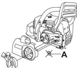
Nasaďte vodiacu lištu na vodiace kolíky. Umiestnite lištu do jej najzadnejšej polohy. Umiestnite reťaz na hnacie reťazové koliesko, umiestnite ju do drážky na vodiacej lište. Začnite na hornom okraji vodiacej lišty.
