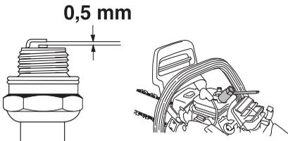
Pamatujte si! Vždy použijte doporučený typ zapalovacích svíček! Použití jiného typu zapalovacích svíček by mohlo poškodit píst či válec. Dbejte na to, aby svíčka měla tzv. radiové odrušení.
