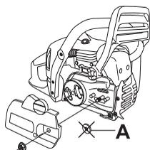
Lištu nasadíte na šroub lišty. Lištu ustavte do její nejzadnější polohy. Řetěz nasadíte na hnací řetězové kolečko a do drážky na liště. Začněte v horní části lišty.
