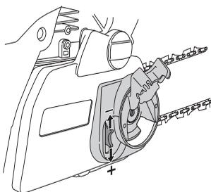
Řetěz je správně napnutý tehdy, když není prověšený pod spodní částí lišty, ale přesto jím lze lehce otočit rukou. Přidržejte hrot lišty a otočením knoflíku ve směru hodinových ručiček upevněte spojku lišty.
