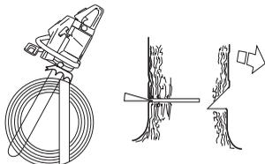
Dokončete hlavní řez rovnoběžně s hranou směrového zářezu, ale tak, aby mezi nimi zůstal nedořez o tloušťce alespoň 1/10 průměru kmene. Tento nedořez kmene bývá označován jako dřevorubecký kloub.
