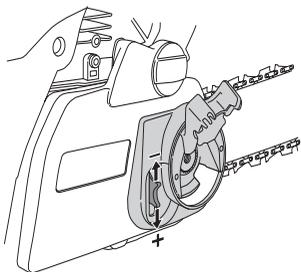
Reťaz je správne napnutá vtedy, keď zospodu neprevisa a dá sa rukou ľahko posúvať. Pevne uchopíte vodiacu lištu a otočením gombíka v smere hodinových ručičiek zatahnete spojku lišty.
