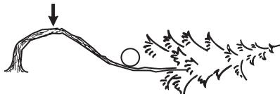
Premyslite si najbezpečnejší spôsob uvoľnenia pnutia a zvážte, či to dokážete bezpečne urobiť. V komplikovaných prípadoch je jedinou bezpečnou metódou odložiť reťazovú pilu a použiť navijak.
