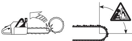
Řezání spodní stranou lišty, tzn. shora dolů, se označuje jako řezání nabíhacím řetězem. V tomto případě řetěz přitahuje pilu směrem ke stromu a přední část těla pily se při řezání bezprostředně opírá o kmen. Řezání nabíhacím řetězem poskytuje uživateli lepší kontrolu nad motorovou pilou a polohou oblasti zpětného rázu.
