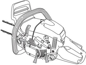
**UPOZORNĚNÍ!** Aby se zachovala správná funkce odstředivého čistícího systému, je nutno pravidelně provádět jeho údržbu. Tato údržba spočívá v čištění sání vzduchu do startéru, lopatek ventilátoru, prostoru kolem oběžného kola ventilátoru, vstupního potrubí a komory karburátoru.
