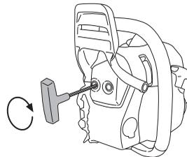
Některé tlumiče výfuku jsou vybaveny speciálním sítkovým lapačem jisker. Pokud vaše zařízení je opatřeno takovým typem tlumiče výfuku, měli byste jeho sítko čistit alespoň jednou za týden. Toto sítko vyčistíte nejlépe ocelovým kartáčem. Ucpaná sítko způsobí přehřátí motoru a může vést k vážnému poškození.
