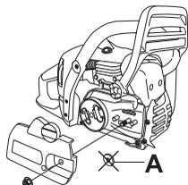
Nasajte vodiacu lištu na vodiace kolíky. Umiestnite lištu do jej najzadnejšej polohy. Umiestnite reťaz na hnacie reťazové koliesko, umiestnite ju do drážky na vodiacej lište. Začnite na hornom okraji vodiacej lišty.
