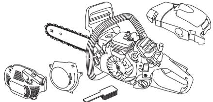
Očistite chladiaci systém raz do týždňa kefkou, príp. pri náročnejších podmienkach častejšie. Špinavý alebo zablokovaný chladiaci systém má za následok prehriatie stroja, ktoré spôsobuje poškodenie piestu a valca.
