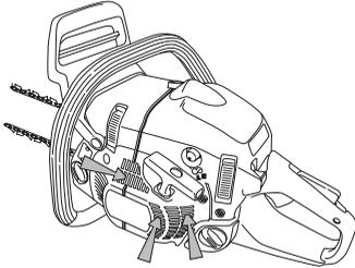
**DÔLEŽITÉ!** Aby systém odstredivého čistenia dobre fungoval, treba ho pravidelne udržiavať. Vyčistite vstup pre prívod vzduchu do štartovacieho zariadenia, rebrá zotrvačníka, priestor okolo zotrvačníka, saciu rúru a priestor karburátora.
