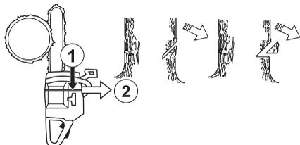
Směrový zářez by měl být veden do hloubky 1/4 průměru kmene a úhel mezi horním a spodním řezem by měl být nejméně 45°.
