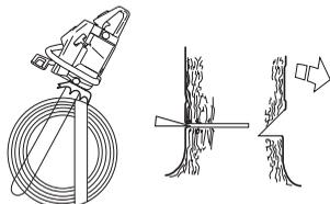
Skončíte hlavný rez vedený súbežne s klinovým rezom tak, aby medzi nimi ostala vzdialenosť minimálne 1/10 priemeru kmeňa. Neprerezaná časť kmeňa medzi hlavným rezom a klinom sa nazýva nedorez.
