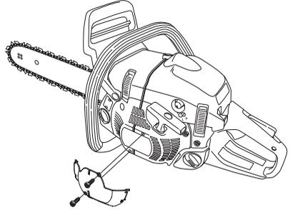
**VAROVÁNÍ!** Jestliže použijete tuto speciální zimní výbavu nebo podniknete jakákoli opatření ke zvýšení teploty, tyto úpravy musí být odstraněny předtím, než bude zařízení použito za normálních teplotních podmínek. V opačném případě hrozí nebezpečí přehřátí, které by mělo za následek vážné poškození motoru.
