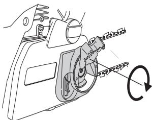
Během doby záběhu po nasazení nového řetězu je zapotřebí často kontrolovat jeho napětí. Kontrolujte napětí řetězu pravidelně. Správně napnutý řetěz zaručuje dobrý řezný výkon a dlouhou životnost.
