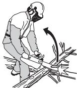
Saetav puu peab olema kontrolli all. Kui te saete väikseid ja kergeid puutükke, võivad need jäädä saeketti kinni ja paiskuda teie vastu. See võib ka mitte ohtlikke kahjustusi tekitada, aga siiski ehmatada ja te võite kaotada kontrolli sae üle. Ärge saagige virna või oksi hunnikus, võtke nad eraldi ette. Saagige ainult ühte tüve või oksa korraga. Võtke lahtisaetud tükid ära ja kontrollige, et teie töökohatoleks kogu aeg korras ja jalgealune kindel.
