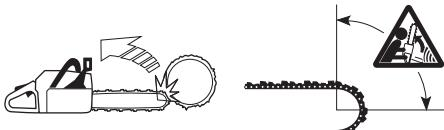
Löikamist juhtplaadi alumise äärega, s.t ülalpoolt löikamist, nimetatakse tömbavaks löikamiseks. Tömbaval löikamisel tömbab kettsaag ennast puu poole ja saag puhkab puul. Tömbava löikamise ajal on sul parem kontroll nii kettsae kui ka tagasiviskumise sektori üle.
