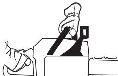
Iedarbiniet droseli ar pilnu jaudu un iedarbiniet kēdes bremzi, pieskaroties rāvienu drošības svirai ar rokas locītavu. Nelaidiet
