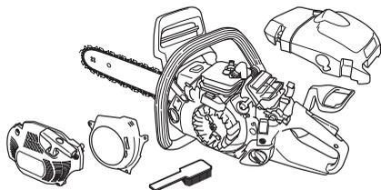
Hladilni sistem očistite s krtačo enkrat tedensko, v zahtevnih pogojih dela pa tudi pogosteje. Umazan ali zamašen hladilni sistem povzroča pregrevanje stroja, to pa poškoduje bat in cilindar.
