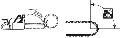
Žaganje s spodnjim robom meča, to se pravi od zgoraj navzdol, se imenuje žaganje na vlek. V tem primeru žago vleče proti deblu, njeno težo pa nosi spodnji rob meča. Ta način žaganja omogoča uporabniku boljši nadzor žage in položaja odbojnega območja meča.
