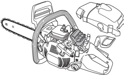
Eine gründlichere Reinigung erfolgt durch Auswaschen des Filters in Seifenwasser.
