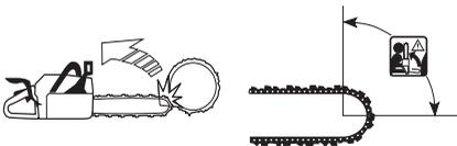
Ein Rückschlag ist immer in Richtung der Führungsschiene gerichtet. Am häufigsten erfolgt der Stoß von Motorsäge und Führungsschiene nach oben und nach hinten zum Anwender. Rückschläge erfolgen
