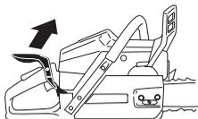
Potisnite sprožilec gor in naprej, da preverite ali se prosto premika in je varno zataknen na pokrov sklopke.
