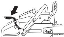
Žage ne nosite ali obešajte za sprožilec! Lahko poškodujete mehanizem in onemogočite zavoro verige.
