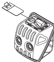
**POZOR!** Med uporabo postane dušilec zelo vroč. To velja tudi v primeru prostega teka. Bodite pozorni na nevarnost požarov, še posebej, ko delate v bližini vnetljivih substanc in/ali plinov.
