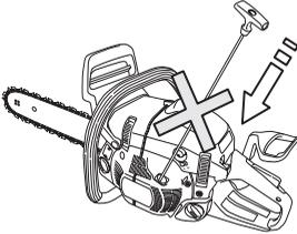
**Hinweis!** Die Kettenbremse rücktstellen, indem der Handschutz zum Handgriffbügel geführt wird. Damit ist die Motorsäge bereit zur Anwendung.
