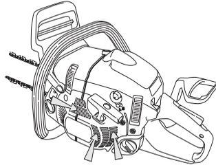
WICHTIG! Um die Funktion der Zentrifugalreinigung aufrecht zu erhalten, muss diese regelmäßig gewartet und gepflegt werden. Den Lufterlass der Startvorrichtung, die Gebläseflügel des Schwungrads, den Raum um das Schwungrad, das Ansaugrohr und den Vergaserraum reinigen.
