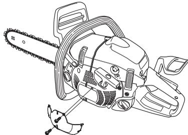
ACHTUNG! Ist ein spezieller Wintersatz montiert und wurden temperatursteigernde Maßnahmen vorgenommen, so müssen diese Modifikationen vor der Anwendung bei normalen Temperaturen wieder rückgängig gemacht werden. Ansonsten besteht die Gefahr, dass das Gerät überhitzt wird, was schwere Motorschäden verursachen kann.
