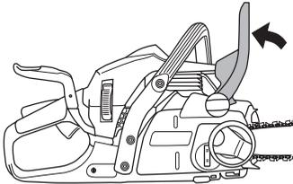
Kettenspannrolle lösen und Kupplungsdeckel (Kettenbremse) entfernen. Transportschutz entfernen.
