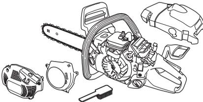
Das Kühlsystem einmal pro Woche mit einer Bürste reinigen, bei schwierigen Verhältnissen öfter. Eine Verschmutzung oder Verstopfung des Kühlsystems führt zur Überhitzung des Gerätes, die Schäden an Zylinder und Kolben zur Folge haben kann.
