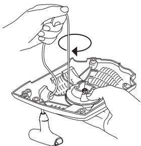
Raztegnite kabel z ročico. Premaknite vaš palec in sprostite kabel. Glejte spodnjo skico.
