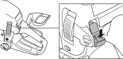
**ACHTUNG!** Der Start/Stopschalter geht automatisch in die Betriebsposition zurück. Um ein ungewolltes Starten zu vermeiden, muss bei Montage, Kontrolle und/oder Wartung daher stets die Zündkappe von der Zündkerze entfernt werden.
