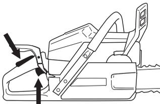
Pred dodajanjem polnega plina za nekaj sekund pustite stroj v prostem teku.
