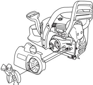
Die Schiene über die Schienenbolzen montieren. Die Schiene in der hintersten Position aufsetzen. Die Kette um das Kettenantriebsrad und in die Schienennut legen. Auf der Oberseite der Schiene beginnen.
