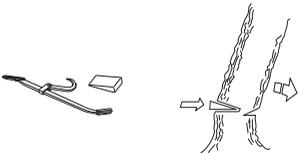
Wir empfehlen eine Führungsschienenlänge zu benutzen, die größer ist als der Stammdurchmesser, sodass Kerb- und Fällschnitt mit einem sog. einfachen Sägeschnitt ausgeführt werden können. Siehe die Anweisungen unter der Überschrift Technische Daten hinsichtlich der Schienenlängen, die für Ihr Motorsägenmodell empfohlen werden.
