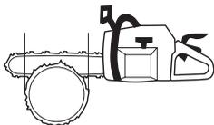
Es gibt Methoden zum Fällen von Bäumen, deren Stammdurchmesser größer ist als die Führungsschienenlänge. Bei solchen Methoden besteht große Gefahr, dass der Rückschlagbereich der Führungsschiene mit einem Gegenstand in Berührung kommt.
