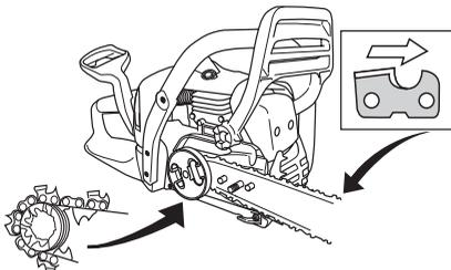
Darauf achten, dass die Schneiden der Sägezähne auf der Schienenoberseite nach vorn gerichtet sind.
