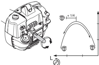
**POZOR!** Če se rezilni priključek vrti, ko je motor v prostem teku, obračajte šobo T v nasprotni smeri urinega kazalca tako dolgo, da se bo priključek ustavil.
