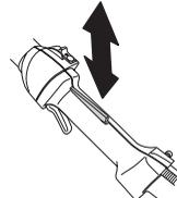
Kontroller at gassregulatoren og gassregulatorsperren går lett og at returfjærsystemet fungerer.
