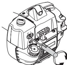
Anna täysi kaasu ja kierrä työkäyntisuutinta H erittäin hitaasti myötäpäivään, kunnes moottorin pyörimisnopeus hidastuu. Kierrä sen jälkeen työkäyntisuutinta H erittäin hitaasti vastapäivään, kunnes moottorin käynti muuttuu epätasaiseksi. Sen jälkeen työkäyntisuutinta H kierretään hitaasti hieman myötäpäivään, kunnes moottori käy tasaisesti.
