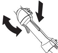
Katso otsikon Käynnistys alla annetut ohjeet. Käynnistä kone ja anna täysi kaasu. Löysää kaasuliipasim ja tarkasta, että terälaite pysähtyy ja pysyy liikkumattomana. Jos terälaite pyörii, kun kaasuliipasim on joutokäyntiasennossa, on kaasuttimen joutokäyntisäätö tarkastettava. Katso otsikon Kunnossapito alla annetut ohjeet.
