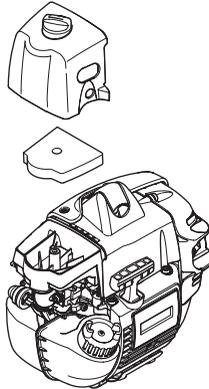
Rengør filteret efter 25 timers drift eller oftere, hvis forholdene er usædvanligt støvede.
