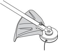
Tarkasta, että suojus on ehjä ja ettei siinä ole halkeamia. Vaihda suojus, jos siihen on kohdistunut iskuja tai siinä on halkeamia.
