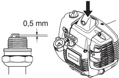
**BEMÆRK!** Brug altid anbefalet tændrørstype! Forkert tændrør kan ødelægge stempel/cylinder. Kontrollér, at tændrøret har såkaldt radiostøjdæmpning.
