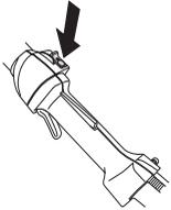
Start motoren og kontroller at motoren blir slått av når stoppbryteren føres til stopstilling.
