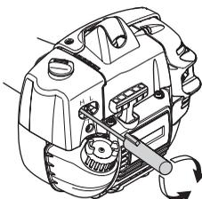
Gi full gass og vri høyturtallsmunnstykket H meget sakte med urviseren til motorhastigheten reduseres. Vri deretter høyturtallsmunnstykket H meget sakte mot urviseren til motoren går ujevnt. Høyturtallsmunnstykket H vris deretter sakte med urviseren en anelse til motoren går jevnt.
