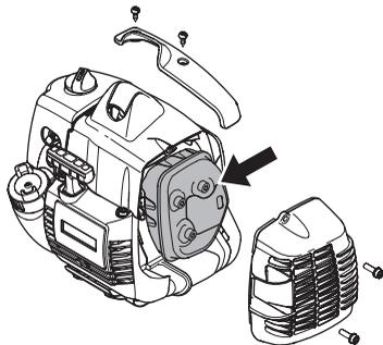
Visse lyddæmpere er udstyret med et specielt gnistfangernet. Hvis din maskine er udstyret med en sådan lyddæmper, bør nettet rengøres en gang om ugen. Dette gøres bedst med en stålbørste. På lyddæmpere uden katalysator bør gnistfangernet rengøres og eventuelt udskiftes en gang om ugen. På katalysatorlyddæmpere skal gnistfangernet kontrolleres og eventuelt rengøres en gang om måneden.
