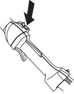
Käynnistä moottori ja tarkasta, että moottori pysähtyy, kun pysäytin siirretään pysäytysasentoon.
