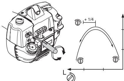
**HUOM!** Jos terälaite pyörii joutokäynnillä, T-ruuvia on kierrettävä vastapäivään, kunnes terälaite pysähtyy.
