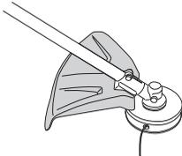
Kontroller at vernet er uskadd og fritt for sprekkdannelser. Skift vernet hvis det er blitt utsatt for slag eller har sprekker.
