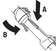
Kontroller at gassregulatoren er låst i tomgangsstilling når gassregulatorsperren er i sin utgangsposisjon.
