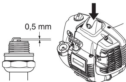
**OBS!** Bruk alltid anbefalt type tennplugg! Feil tennplugg kan ødelegge stempel/sylindere. Påse at tennpluggen har såkalt radiostøyfilter.
