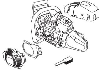
Das Kühlsystem einmal pro Woche mit einer Bürste reinigen, bei schwierigen Verhältnissen öfter. Eine Verschmutzung oder Verstopfung des Kühlsystems führt zur Überhitzung des Gerätes, die Schäden an Zylinder und Kolben zur Folge haben kann.
