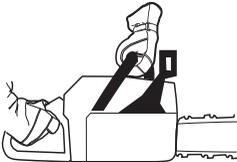
Poženite motor s polnim plinom in sprožite zavoro verige, tako da z levim zapestjem odsunete ščitnik odsunka. Pri tem ne spustite sprednjega ročaja. **Veriga se mora v trenutku ustaviti.**
