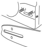
Verigo napnite s kombiniranim ključem tako, da obračate vijak za napenjanje verige v smeri urinega kazalca. Verigo
