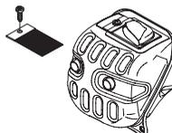
Der Schalldämpfer hat die Aufgabe, den Schallpegel zu dämpfen und die Abgase vom Anwender wegzuleiten. Die
