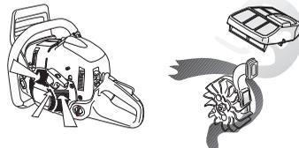
**WICHTIG!** Um die Funktion der Zentrifugalreinigung aufrecht zu erhalten, muss diese regelmäßig gewartet und gepflegt werden. Den Luftereinlass der Startvorrichtung, die Gebläseflügel des Schwungrads, den Raum um das Schwungrad, das Ansaugrohr und den Vergaserraum reinigen.
