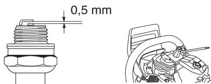
Hinweis! Stets den vom Hersteller empfohlenen Zündkerzentyp verwenden! Eine ungeeignete Zündkerze kann Kolben und Zylinder zerstören. Dafür sorgen, dass die Zündkerze eine sog. Funkenstörung hat.
