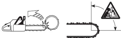
Žaganje s spodnjim robom meča, to se pravi od zgoraj navzdol, se imenuje žaganje na vleč. V tem primeru žago vleče proti deblu, njeno težo pa nosi spodnji rob meča. Ta način žaganja omogoča uporabniku boljši nadzor žage in položaja odbojnega območja meča.
