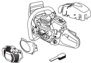
Hladilni sistem očistite s krtačo enkrat tedensko, v zahtevnih pogojih dela pa tudi pogosteje. Umazan ali zamašen hladilni
