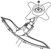
Trekk til mutteren mot skjæreutstyrets rotasjonsretning ved montering. Løse mutteren i skjæreutstyrets rotasjonsretning ved demontering. (OBS! Mutteren er
