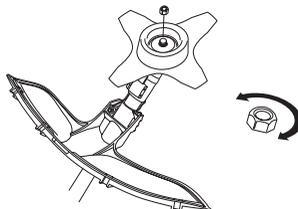
Låsemøtrikkens nylonlås må ikke være så slidt, at den kan drejes med fingrene. Låsen skal holde mindst 1,5 Nm. Møtrikken skal udskiftes, når den har været skruet på ca. 10 gange.
