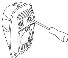
Er din maskines lyddæmper udstyret med et gnistfangernet, skal dette renses regelmæssigt. Et
