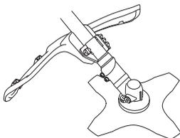
Kontrollér, at beskyttelsen er intakt og fri for revner. Udskift beskyttelsen, hvis den har været udsat for slag eller har revner.
