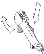
Se anvisningerne under overskriften Start. Start maskinen, og giv fuld gas. Slip gasreguleringen, og kontrollér, at skæreudstyret standser, og at det forbliver i stilstand. Hvis skæreudstyret roterer med gasreguleringen i tomgangsstilling, skal karburatorens
