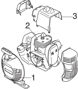
Jäähdytysjärjestelmän osat ovat:
