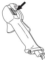
**HUOM!** Pysäytyskosketin palautuu automaattisesti käynnistysasentoon. Sen vuoksi, tahattoman käynnistykseen estämiseksi, sytytystulpan suojus on aina irrotettava sytytystulpasta asennuksen, tarkastuksen ja/ tai huollon ajaksi.
