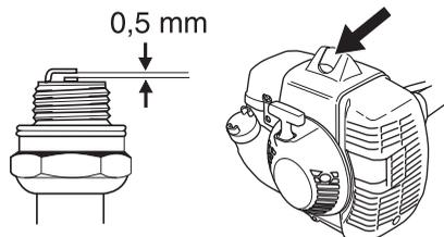
**BEMÆRK!** Brug altid anbefalet tændrørstype! Forkert tændrør kan ødelægge stempel/cylinder.
