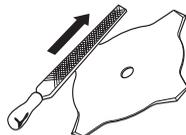
Sørg for, at udlægningen på savklingen er korrekt! Følg vores instruktioner, og brug det anbefalede udlæggerværktøj. En forkert udlagt savklinge øger risikoen for fastlåsning og kast samt skader på savklingen.
