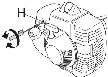
Legg merke til at motoren skal være belastet ved justering av høyerturtallsmunnstykket H. Monter derfor trimmerhode T35 (2,7 mm line) for justering av høyerturtallsmunnstykket skjer. Linelengden skal være standard, dvs. til kniven på trimmerdekselet.
