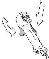
Katso otsikon Käynnistys alla annetut ohjeet. Käynnistä kone ja anna täysi kaasu. Löysää kaasuliipasin ja tarkasta, että terälaite pysähtyy ja pysyy liikkumattomana. Jos terälaite pyörii, kun kaasuliipasin on joutokäyntiasennossa, on kaasuttimen joutokäyntiasäätö tarkastettava. Katso otsikon Kunnossapito alla annetut ohjeet.
