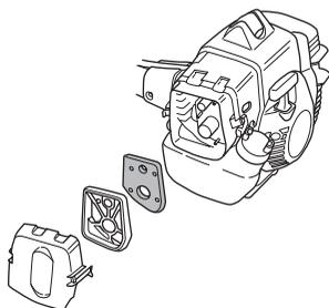
Rengjør luftfilteret etter 25 timers drift, oftere hvis maskinen brukes under forhold med usedvanlig mye støv.
