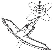
Spænd møtrikken mod skæreudstyrets rotationsretning ved montering. Løsn møtrikken i skæreudstyrets rotationsretning ved afmontering. (OBS! Møtrikken har
