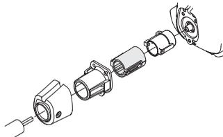
Kontrollera regelbundet avvibreringselementen efter materialsprickor och deformationer.
