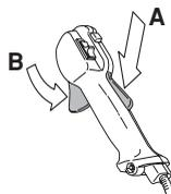
Kontrollér, at gasreguleringen er låst i tomgangsstilling, når gasreguleringslåsen befinder sig i udgangsstilling.
