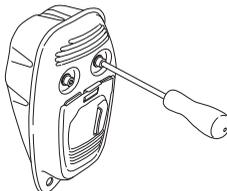
Är din maskins ljuddämpare utrustad med ett gnistfångarnät, skall detta rengöras regelbundet. Ett igensatt nät leder till varmkörning av motorn med allvarlig motorskada som följd.
