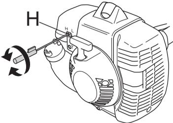
Observera att motorn ska vara belastad vid justering av högvarvsmunestycket H. Montera därför trimmerhuvud T35 (2.7mm lina) innan justering av högvarvsmunestycket sker. Linlängden skall vara standard, dvs. till kniven på trimmerskyddet.
