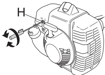
Bemærk, at motoren skal være belastet, når du justerer højomdrejningsdysen H. Monter derfor trimmerhovedet T35 (2,7mm line), før du justerer højomdrejningsdysen. Linelængden skal være standard, dvs. til kniven på trimmerbeskyttelsen.
