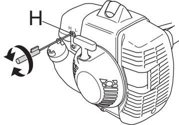
Huomaa, että moottorin tulee olla kuormittuna, kun säädät työkäyntisuutinta H. Asenna sen vuoksi trimmipää T35 (2,7 mm:n siima) ennen työkäyntisuuttimen säätämistä. Siimanpituuden tulee olla vakio, eli trimmisuojuksen terään.
