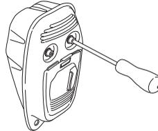
Jos koneesi äänenvaimennin on varustettu kipinänsammutusverkolla, on myös se puhdistettava
