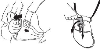
Tarkasta, että valjaiden hihnat on asetettu oikein. Kun valjaat ja kone on säädetty, tarkasta, että valjaiden pikairrotin toimii.
