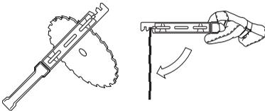
Tarkasta terälaite vaurioiden ja halkeamien varalta. Vaurioitunut terälaite on aina vaihdettava.
