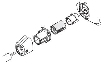
Kontroller regelmessig avvibreringselementene ved tanke på materialsprekker og deformering.
