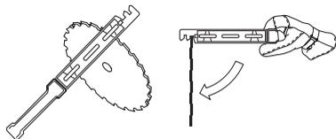
Kontroller skjæreutstyret med henblikk på skader og sprekkdannelse. Skadet skjæreutstyr må alltid skiftes.
