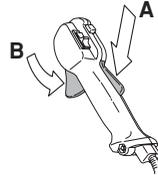
Kontroller at gassregulatoren er låst i tomgangsstilling når gassregulatorsperren er i sin utgangsposisjon.
