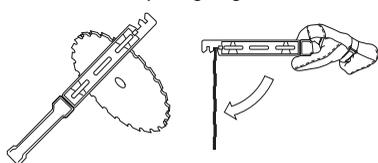
Kontrollera skärutrustningen med avseende på skador och sprickbildning. En skadad skärutrustning ska alltid bytas ut.
