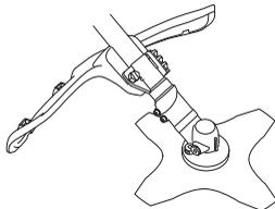
Tarkasta, että suojus on ehjä ja ettei siinä ole halkeamia. Vaihda suojus, jos siihen on kohdistunut iskuja tai siinä on halkeamia.
