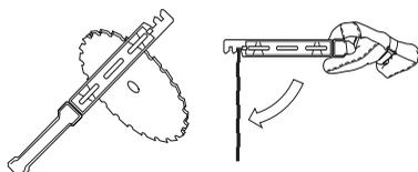
Kontrollér skæreudstyret med hensyn til skader og revnedannelse. Et beskadiget skæreudstyr skal altid udskiftes.
