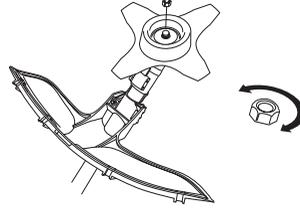
Lukitusmutterin nailonlukitus ei saa olla niin kulunut, että sitä voi ruuvata käsin. Lukituksen on kestettävä vähintään 1,5 Nm. Mutteri on vaihdettava, kun se on ruuvattu kiinni noin 10 kertaa.
