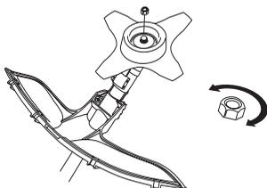
Låsmutterns nylonlåsning får ej vara så sliten att den kan skruvas med fingrarna. Låsningen ska hålla minst 1,5 Nm. Muttern ska bytas efter det att den skruvats på ca 10 gånger.
