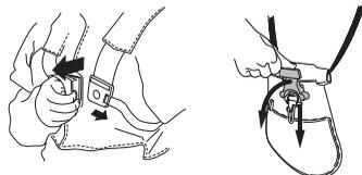
Kontrollér, at selens remme er korrekt placeret. Når selen og maskinen er justeret, skal det kontrolleres, at selens snapudløsning fungerer.
