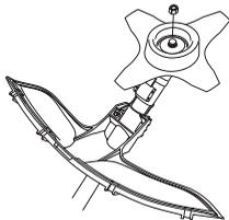
Vid montering, drag åt muttern mot skärutrustningens rotationsriktning. Vid demontering, lossa muttern i skärutrustningens rotationsriktning. (OBS! Muttern är vänstergängad.) Drag åt muttern med klingmutternnyckeln.
