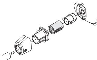
Kontrollér regelmæssigt vibrationsdæmpningselementerne for materialerevner og deformationer
