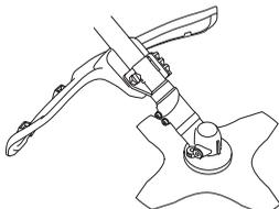
Kontrollera att skyddet är oskadat och fritt från sprickbildning. Byt skydd om det utsatts för slag eller har sprickor.
