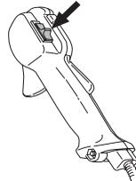
**BEMÆRK!** Stopkontakten skifter automatisk til startposition. For at undgå utilsigtet start skal tændhætten derfor altid tages af tændrøret ved montering, kontrol og/eller vedligeholdelse.
