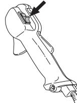
**OBS!** Stoppkontakten återgår automatiskt till startläge. För att undvika ofrivillig start, måste därför alltid tändhatten avlägsnas från tändstiftet vid montering, kontroll och/eller underhåll.
