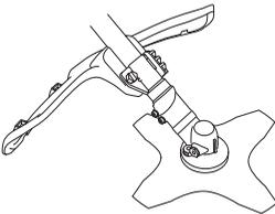
Kontroller at vernet er uskadd og fritt for sprekkdannelser. Skift vernet hvis det er blitt utsatt for slag eller har sprekker.
