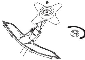
Låsemutterens nylonlåsning må ikke være så slitt at den kan skrus med fingrene. Låsningen må holde minst 1,5 Nm. Mutteren må skiftes etter at den har vært skrudd på ca. 10 ganger.
