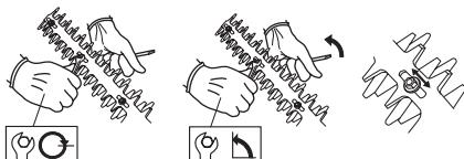
Ved korrekt justerte kniver skal det, målt ved skruene, være en klarering mellom knivene på 0,2-0,4 mm.
