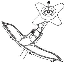
Pose: serrer l'écrou dans le sens contraire de la rotation de l'équipement de coupe. Dépose: desserrer l'écrou dans le sens de la rotation de l'équipement de coupe. (NOTA!
