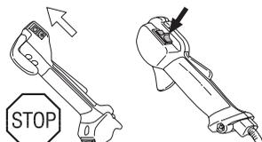
Mettre le moteur en marche et s'assurer qu'il s'arrête lorsque le bouton d'arrêt est amené en position d'arrêt.
