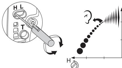
**REMARQUE!** Pour un réglage optimal du carburateur, il convient de faire appel à un revendeur qualifié/atelier de réparation disposant d'un compte-tours.
