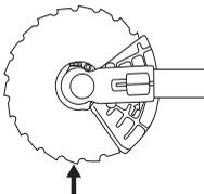
Les dents de la lame d'éclaircissage risquent de causer des blessures aussi bien lors du serrage que du desserrage de l'écrou de la lame. Veiller à ce que la main soit toujours protégée par le protège-lame lors de ces interventions. Toujours utiliser une clé à douille munie d'un manche assez long. La flèche sur l'illustration
