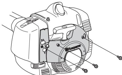
Démonter le filtre à air et le couvercle de filtre à air de la machine. Monter le filtre à air et le couvercle de filtre à air fournis avec le kit spécial hiver.
