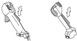
Vérifier que le blocage de l'accélération, la commande d'accélération et leurs ressorts de rappel fonctionnent correctement.
