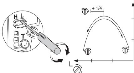
**REMARQUE!** Si l'équipement de coupe tourne au ralenti, tourner le pointeau de ralenti T dans le sens contraire des aiguilles jusqu'à l'arrêt de l'équipement de coupe.
