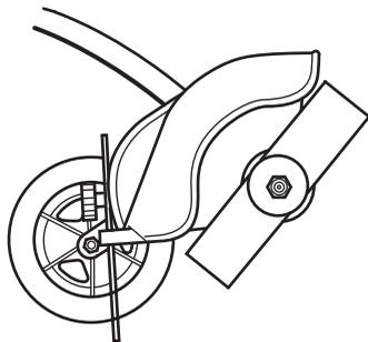
S'assurer que la protection est intacte et qu'elle ne présente pas de fissures. Remplacer la protection si elle a subi des coups ou si elle présente des fissures.
