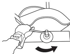
Pose: serrer l'écrou dans le sens contraire de la rotation de l'équipement de coupe. Dépose: desserrer l'écrou dans le sens de la rotation de l'équipement de coupe. (NOTA! L'écrou est fileté à gauche.)
