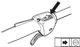
Mettre le moteur en marche et s'assurer qu'il s'arrête lorsque le bouton d'arrêt est amené en position d'arrêt.
