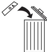
Une lame déséquilibrée entraîne d'importantes vibrations qui risquent d'endommager la machine.
