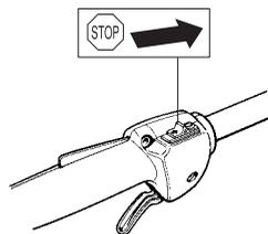
**REMARQUE!** L'interrupteur d'arrêt se remet automatiquement en position de démarrage. Toujours retirer le chapeau de bougie de la bougie lors du montage, contrôle et/ou entretien, afin d'éviter tout démarrage accidentel.
