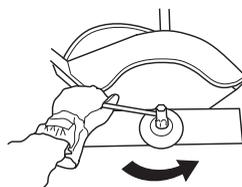
Pose: serrer la vis dans le sens contraire de la rotation de l'équipement de coupe. Dépose: desserrer la vis dans le sens de la rotation de l'équipement de coupe. (NOTA! La vis est fileté à gauche.)
