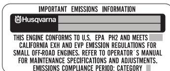
L'étiquette du moteur certifie que le produit est conforme aux exigences en matière d'émissions de gaz d'échappement EPA Ph II et aux exigences californiennes relatives aux gaz d'échappement et aux émissions dans l'air CARB Tier III. La période d'application à laquelle il est fait référence sur l'étiquette des émissions indique le nombre d'heures de fonctionnement pour lesquelles le moteur a été déclaré conforme aux exigences californiennes et fédérales en matière d'émissions.
