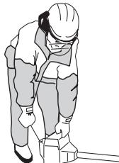
**REMARQUE!** Ne pas sortir complètement la corde du lanceur et ne pas lâcher la poignée avec la corde du lanceur complètement sortie. Cela pourrait endommager la machine.
