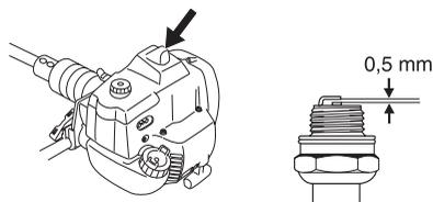
**REMARQUE!** Toujours utiliser le type de bougie recommandé! Une bougie incorrecte peut endommager le piston/le cylindre. S'assurer que la bougie est dotée d'un antiparasites.
