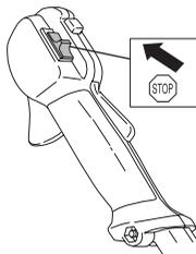
**REMARQUE!** L'interrupteur d'arrêt se remet automatiquement en position de démarrage. Toujours retirer le chapeau de bougie de la bougie lors du montage, contrôle et/ou entretien, afin d'éviter tout démarrage accidentel.
