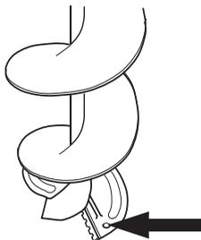
La méthode d'affûtage perfectionnée qui est utilisée lors de la fabrication des taillants est la seule qui convient, par opposition aux méthodes d'affûtage classiques. Toujours remplacer les taillants de votre perforatrice rotative lorsqu'ils sont usés afin d'obtenir un fonctionnement optimal.
