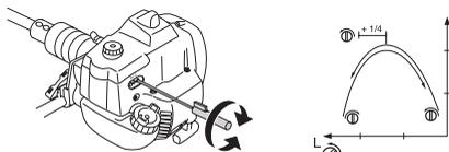
**REMARQUE!** Si les lames tournent au ralenti, tourner le pointeau de ralenti T dans le sens contraire des aiguilles d'une montre jusqu'à l'arrêt des lames.
