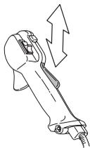
Vérifier que le blocage de l'accélération, la commande d'accélération et leurs ressorts de rappel fonctionnent correctement.
