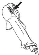
Mettre le moteur en marche et s'assurer qu'il s'arrête lorsque le bouton d'arrêt est amené en position d'arrêt.
