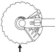
Beim Lösen und Anziehen der Sägeklingennutter besteht die Gefahr, dass man sich an den Zähnen der Sägeklinge verletzt. Daher darauf achten, dass die Hand bei dieser Arbeit durch den Klingenschutz geschützt ist. Immer einen Hülsen Schlüssel mit ausreichend langem Schaft verwenden, damit dies möglich ist. Der Pfeil in der
