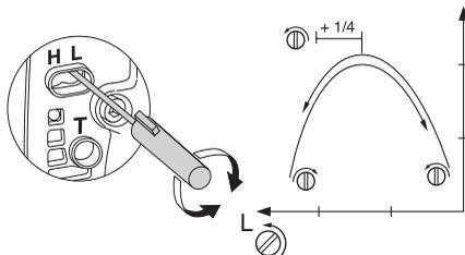
**POZOR!** Če se rezilni priključek vrti, ko je motor v prostem teku, obračajte šobo T v nasprotni smeri urinega kazalca tako dolgo, da se bo priključek ustavil.
