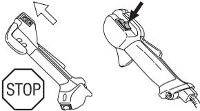
Den Motor starten und kontrollieren, ob der Motor stoppt, wenn der Stopschalter in Stoppstellung geführt wird.
