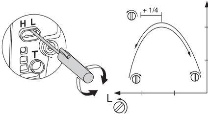
**ACHTUNG!** Wenn die Schneidausrüstung sich im Leerlauf dreht, ist die T-Schraube gegen den Uhrzeigersinn zu drehen, bis die Schneidausrüstung stehenbleibt.
