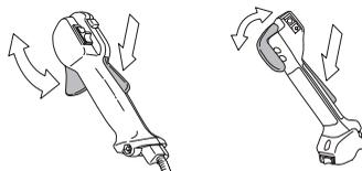
Glej poglavje pod naslovom Vžig. Vžgite stroj in mu dajte polni plin. Izpustite plinsko ročico in se prepričajte, da se rezilni priključek ustavi in obmiruje. Če se rezilni priključek vrtil, ko je plinska ročica v legi prostega teka, preglejte nastavitve uplinjača v prosti legi. Glejte navodila v poglavju Vzdrževanje.
