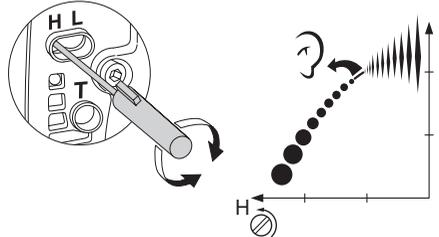
**ACHTUNG!** Zur optimalen Einstellung des Vergasers sollte man sich an einen Fachhändler/eine Servicewerkstatt wenden, die über einen Drehzahlmesser verfügen.
