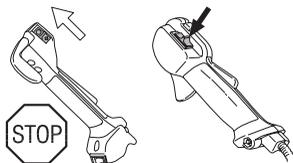
Vžgite motor in preverite, če se ustavi, ko izklopno stikalo potisnete v položaj STOP.
