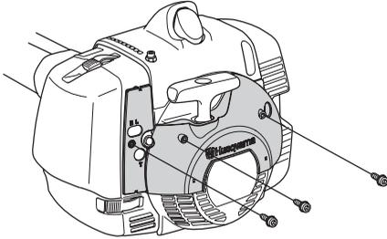
Odstranite zračni filter in pokrov zračnega filtra iz stroja. Namestite zračni filter in pokrov zračnega filtra iz zimske opreme.
