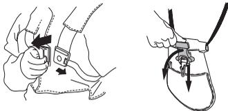
Kontrollieren, ob die Riemen des Tragegurtes richtig liegen. Wenn Tragegurt und Gerät angepasst sind, kontrollieren, ob der Schnellverschluss des Tragegurtes funktioniert.
