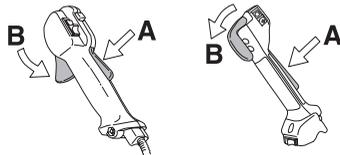
Kontrollieren, ob der Gashebel in Leerlaufstellung gesichert ist, wenn sich die Gashebelsperre in Ausgangsstellung befindet.
