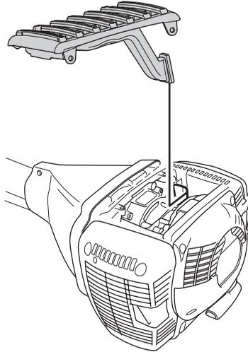
**POMEMBNO!** Pri temperaturah višjih kot -5°C oziroma 0°C MORATE stroju nastaviti tako, kot je nastavljen tovarniško. V nasprotnem primeru tvegate pregrevanje, posledica pa bodo resne poškodbe motorja.
