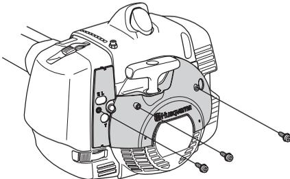
Luftfilter und Luftfilterdeckel der Maschine demontieren.
