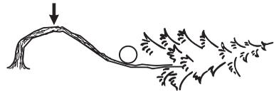
Überlegen Sie, wie die Spannung am sichersten beseitigt werden kann, und ob Sie dies schaffen. Ist die Situation zu kompliziert, gibt es nur eine sichere Methode nämlich anstelle der Motorsäge eine Winde zu benutzen.
