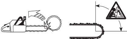
Ein Rückschlag ist immer in Richtung der Führungsschiene gerichtet. Am häufigsten erfolgt der Stoß von Motorsäge und Führungsschiene nach oben und nach hinten zum Anwender. Rückschläge erfolgen aber auch in andere Richtungen, je nachdem in welcher
