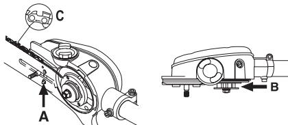
Die Kette durch Schrauben der Kettenspannerschraube im Uhrzeigersinn spannen. Den Kombischlüssel benutzen oder von Hand schrauben. Die Kette ist zu
