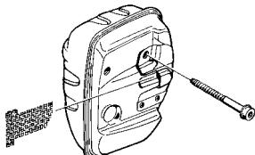
Sur les silencieux sans pot catalytique, la grille doit être nettoyée et si nécessaire remplacée une fois par semaine. Sur les machines dont le silencieux est muni d'un pot catalytique, la grille devra être inspectée et si nécessaire nettoyée une fois par mois. **Si la grille est abimée, elle devra être remplacée.**
