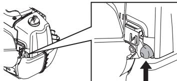
**Choke:** Zet de choke-hendel in de choke-positie.
