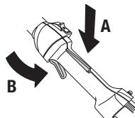
Vérifier d'abord que la commande de l'accélération est bloquée en position de ralenti quand le blocage de l'accélération est en position initiale.
