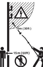
La machine a une longue portée. Vérifier qu'aucune personne et qu'aucun animal ne se trouvent à moins de 15 mètres quand la machine est utilisée.
