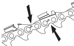
We raden aan een nieuwe zaagketting te gebruiken om de slijtage van de ketting die u gebruikt te controleren.
