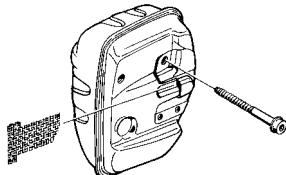
Op geluiddempers zonder katalysator moet het net één keer per week worden schoongemaakt en eventueel worden vervangen. Op geluiddempers met katalysator moet het net één keer per maand worden gecontroleerd en eventueel schoongemaakt. **Bij evt. beschadigingen aan het net moet dit vervangen worden.**
