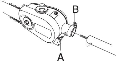
ACHTUNG! Darauf achten, dass die Antriebswelle am Führungsrohr genau in die Aussparung am Schneidkopf eingepasst wird.
