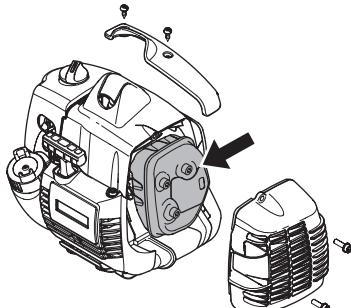
Bepaalde geluiddempers zijn voorzien van een speciaal vonkenopvangnet. Indien uw machine uitgerust is met zo'n geluiddempers, moet u het net minstens één keer per week schoonmaken. Gebruik bij voorkeur een stalen borstel.
