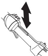
Kontrollieren, ob Gashebel und Gashebelsperre mit dem dazugehörigen Rückzugfederungssystem leicht funktionieren.
