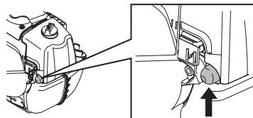
**Choke:** Den Chokehebel in Choke-Lage führen.
