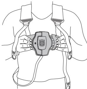
Controleer of de riemen van het draagstel juist zitten. Wanneer het draagstel en de machine afgesteld zijn, moet u controleren of de snelontgrendeling van het draagstel werkt.
