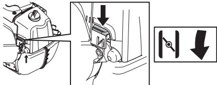
**WAARSCHUWING!** Wanneer de motor wordt gestart met de chokehendel in de choke- of startgasstand begint de snijuitrusting direct te draaien.
