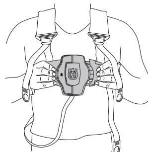
Kontrollieren, ob die Riemen des Tragegurtes richtig liegen. Wenn Tragegurt und Gerät angepasst sind, kontrollieren, ob der Schnellverschluss des Tragegurts funktioniert.
