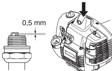
**ACHTUNG!** Stets den vom Hersteller empfohlenen Zündkerzentyp verwenden! Eine ungeeignete Zündkerze kann Kolben und Zylinder zerstören. Dafür sorgen, dass die Zündkerze eine sog. Funkentstörung hat.
