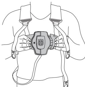
S'assurer du bon positionnement des bretelles du harnais. Quand le harnais et la machine sont ajustés, contrôler le bon fonctionnement du dispositif de libération rapide du harnais.
