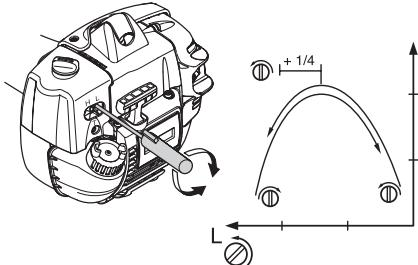
**REMARQUE!** Si l'équipement de coupe tourne au ralenti, tourner le pointeau de ralenti T dans le sens contraire des aiguilles jusqu'à l'arrêt de l'équipement de coupe.
