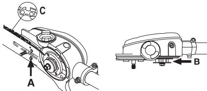
Span de ketting door de kettingspanschroef met de klok mee te draaien. Gebruik een combiseleutel of draai met de
