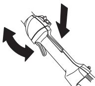
Zie de aanwijzingen in het hoofdstuk Start. Start de heggenzaag en geef vol gas. Laat de gashendel los en controleer of de messen stoppen en stil blijven staan. Als de messen bewegen wanneer de gashendel in stationairstand staat, moet het stationair toerental van de carburateur afgesteld worden. Zie de aanwijzingen in het hoofdstuk Onderhoud.
