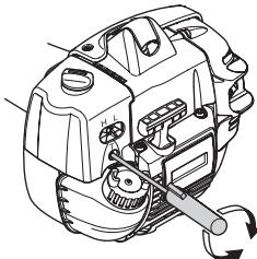
**AVERTISSEMENT!** S'il est impossible de régler le régime de ralenti de manière à immobiliser l'équipement de coupe, contacter le revendeur ou l'atelier de réparation. Ne pas utiliser la machine tant qu'elle n'est pas correctement réglée ou réparée.
