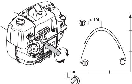
**ACHTUNG!** Wenn die Schneidausrüstung sich im Leerlauf dreht, ist die T-Schraube gegen den Uhrzeigersinn zu drehen, bis die Schneidausrüstung stehenbleibt.
