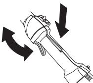
Siehe die Anweisungen unter der Überschrift Start. Die Heckenschere starten und Vollgas geben. Den Gashebel loslassen und kontrollieren, ob die Messer völlig zum Stillstand kommen. Wenn die Messer sich bewegen, während sich der Gashebel in Leerlaufstellung befindet, ist der Leerlauf des Vergasers einzustellen. Siehe die Anweisungen unter der Überschrift Wartung.
