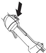
Mettre le moteur en marche et s'assurer qu'il s'arrête lorsque le bouton d'arrêt est amené en position d'arrêt.
