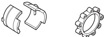
Kontroller regelmessig avvibreringselementene med tanke på materialsprekker og deformering. Kontroller at avvibreringselementene er hele og fast forankret.
