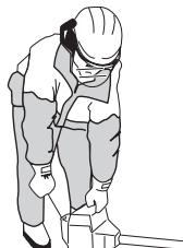
**BEMÆRK!** Anbring ikke nogen legemsdele på den markerede overflade. Kontakt kan medføre forbrændinger af huden eller elektrisk stød, hvis tændhætten er defekt.
