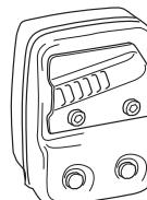
I lande med varmt og tørt klima er risikoen for brand åbenbar. Vi har derfor udstyret visse lyddæmpere med et såkaldt gnistfangernet. Kontrollér, om din maskine har et sådant net.
