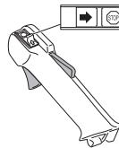
**BEMÆRK!** Stopkontakten skifter automatisk til startposition. For at undgå utilsigtet start skal tændhætten derfor altid tages af tændrøret ved montering, kontrol og/eller vedligeholdelse.
