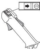
**OBS!** Stoppkontakten återgår automatiskt till startläge. För att undvika ofrivillig start, måste därför alltid tändhatten avlägsnas från tändstiftet vid montering, kontroll och/eller underhåll.
