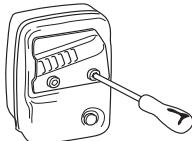
Jos konesi äänenvaimennin on varustettu kipinänsammatusverkolla, on myös se puhdistettava säännöllisesti. Tukkeutunut verkko aiheuttaa moottorin kuumentemisen, mistä seuraa vakava moottorivaurio.
