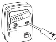
Er din maskines lyddæmper udstyret med et gnistfangernet, skal dette renses regelmæssigt. Et tilstoppet net medfører, at motoren kører varm med alvorlig motorskade til følge.
