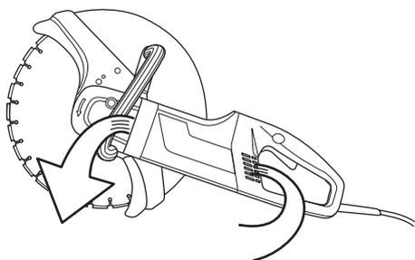
Pour que le refroidissement de la machine fonctionne correctement, les ouvertures de l'air de refroidissement doivent être propres et ne pas être bouchées. Nettoyer régulièrement la machine à l'air comprimé.
