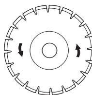
Une flèche se trouve à l'arrière de la machine et indique le sens de rotation de l'arbre du disque.
