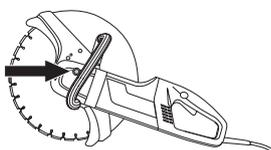
Si une lame diamant est montée sur la découpeuse, veiller à ce qu'elle tourne dans la direction indiquée par la flèche sur la lame.
