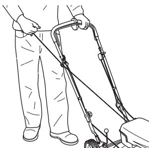
**OBS!** Dra ikke startsnoren helt ut og slipp heller ikke håndtaket fra helt utdratt stilling. Dette kan skade maskinen.
