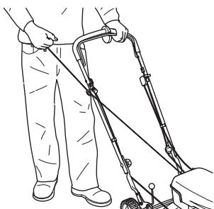
**BEMÆRK!** Træk ikke startsnoren helt ud, og slip heller ikke starthåndtaget fra udstrakt stilling. Dette kan give skader på maskinen.
