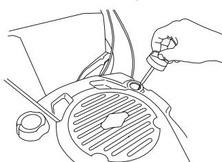
Oljepåfyllningslocket måste vara helt nerskrutat för att ge en korrekt bild av oljenivån.
