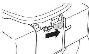
Fyll inte på för mycket bensin. Lämna ungefär 35 mm under tanklocket så att bränslet kan expandera.
