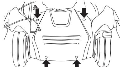
Klippedekselet er konstruert for å redusere vibrasjoner og for å redusere risikoen for kuttskader. Kontroller at klippedekselet er helt og uten synlige defekter, f.eks. materialsprekker.
