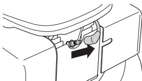
Kierrä öljyntäytökorkki auki ja tarkasta öljymäärä korkissa olevasta mittatikusta.
