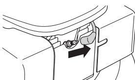
Skruta loss oljepåfyllningslocket och kontrollera oljenivån på mätstickan som sitter på locket.
