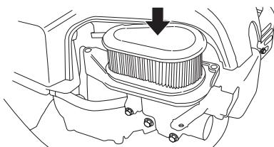
Rengjør filteret ved å banke det mot et plant underlag. Bruk aldri løsemiddel med petroleum, f.eks. parafin, eller trykkluft for å rengjøre filteret.
