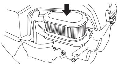
Rengör filtret genom att knacka filtret mot ett plant underlag. Använd aldrig lösningsmedel med petroleum t.ex. fotogen, eller tryckluft för att rengöra filtret.
