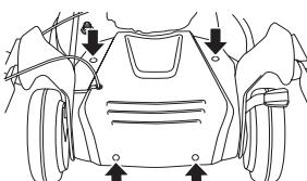
Klippeskjoldet er konstrueret til at reducere vibrationerne og til at mindske risikoen for skæreskader. Kontrollér, at klippeskjoldet er helt og uden synlige defekter, f.eks. materialerevner.
