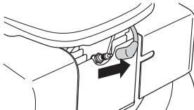
Skru oliepåfyldningslåget af, og kontrollér olieniveauet på målepinden, der sidder på låget.
