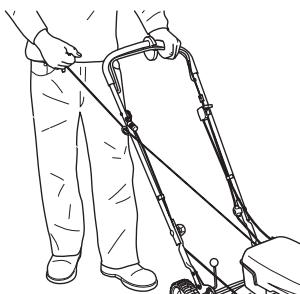
OBS! Drag inte ut startlinan helt och släpp inte heller starthandtaget från helt utdraget läge. Detta kan orsaka skador på maskinen.
