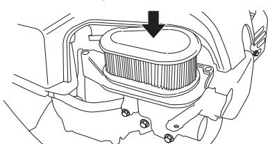
Rengør filtret ved at slå det imod et plant underlag. Brug aldrig opløsningsmidler med petroleum eller trykluft til at rense filtret.
