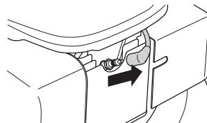
Påfyld ikke for meget benzin. Lad der være ca. 35 mm op til tanklåget, så benzin'en kan udvide sig.
