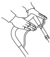
Bremsebøylen må aldri være permanent forankret i håndtaket når maskinen er i gang.
