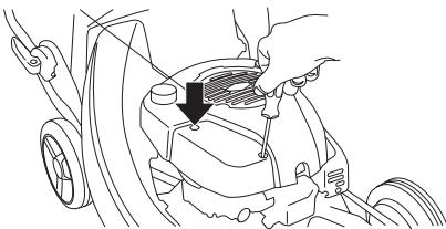
Ta bort luftfiltret och kontrollera att det är helt. Byt till nytt luftfilter om du märker att det är bristfälligt.
