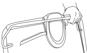
Tartu käynnistyskahvasta, vedä käynnistysnarusta hitaasti oikealla kädellä, kunnes tunnet vastuksen (kytkentäkynnet tarttuvat) ja vedä sen jälkeen nopein ja voimakkain vedoin. **Älä koskaan kiedo käynnistysnarua kätesi ympärille.**
