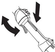
Vedi istruzioni alla voce Avviamento. Avviare il motore ed accelerare a pieno gas. Lasciar andare l'acceleratore e accertarsi che il gruppo di taglio di taglio si fermi e resti fermo. Se il gruppo di taglio ruota mentre l'acceleratore è al minimo è necessario controllare la registrazione del
