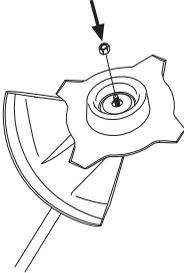
Κατά τη συναρμολόγηση, σφίξτε το παξιμάδι στρέφοντάς το αντίθετα προς τη φορά περιστροφής του εξαρτήματος κοπής. Χαλαρώστε το παξιμάδι για να το αφαιρέσετε, στρέφοντάς το κατά τη φορά περιστροφής του εξαρτήματος κοπής. (ΠΡΟΣΟΧΗ! το παξιμάδι έχει αριστερόστροφο σπείρωμα.) Σφίξτε το παξιμάδι με το σωληνωτό κλειδί.
