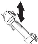
Controllare che acceleratore e fermo del gas si muovano liberamente e che le molle di richiamo funzionino a dovere.
