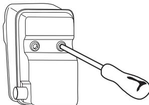
Se a sua máquina estiver equipada com um abafachamas, este deverá ser submetido a uma limpeza periódica. A rede obstruída leva a um aquecimento que pode acarretar sérios danos para o motor.
