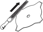
Ελέγχετε το εξάρτημα κοπής για ζημιές ή εμφάνιση ραγισμάτων. Το κατεστραμμένο εξάρτημα κοπής πρέπει πάντα να αντικαθίσταται.
