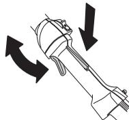
Consulte las instrucciones bajo el título Arranque. Ponga en marcha la máquina y acelere al máximo. Suelte el acelerador y controle que el equipo de corte se detenga y permanezca inmóvil. Si el equipo de corte gira con el acelerador en ralentí, se debe controlar la regulación del
