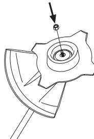
Para el montaje, apriete la tuerca girándola en sentido contrario al sentido de rotación del equipo de corte. Para el desmontaje, afloje la tuerca girándola en el sentido de rotación del equipo de corte. (NOTA: La tuerca tiene
