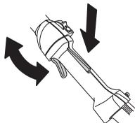
Veja instruções na secção Arranque. Arranque com a máquina e acelere a fundo. Solte o acelerador e verifique se o equipamento de corte pára e permanece imóvel. Se o equipamento de corte girar com o acelerador na marcha em vazio, controle o ajuste da marcha em vazio do carburador. Ver instruções no capítulo Manutenção.
