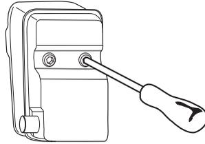
Εάν ο σιγαστήρας του μηχανήματος σας έχει και διχτυωτό φίλτρο σπινθήρων, θα πρέπει να το καθαρίζετε τακτικά. Ένα γεμάτο ακαθαρσίες φίλτρο σπινθήρων προκαλεί υπερθέρμανση του κινητήρα, κάτι που μπορεί να καταλήξει σε σοβαρή βλάβη.
