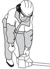
**NOTA!** Não colocar nenhuma parte do corpo na superfície marcada. Contacto com a mesma pode resultar em queimaduras na pele ou choque eléctrico se a protecção da vela estiver defeituosa. Use sempre luvas. Nunca utilize uma máquina com a protecção da vela defeituosa.
