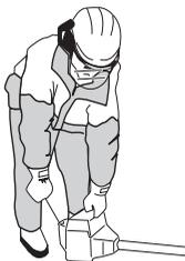
**¡NOTA!** No poner ninguna parte del cuerpo en la superficie marcada. El contacto puede causar quemaduras en la piel o sacudidas eléctricas si el excitador de ignición es defectuoso. Utilice siempre guantes protectores. No emplee nunca una máquina con un excitador de ignición defectuoso.
