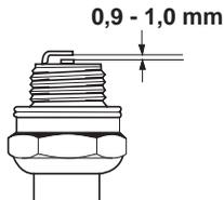
**NOTA!** Use sempre o tipo de vela de ignição recomendado! Uma vela de ignição incorrecta pode danificar o pistão/cilindro. Verifique se a vela de ignição não produz interferências de rádio.
