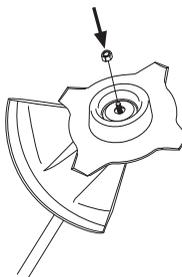
Durante il montaggio, avvitare il dado girando in senso contrario a quello di rotazione del gruppo di taglio. Durante lo smontaggio, svitare il dado nel senso di rotazione del gruppo di taglio. (NOTA! La filettatura del
