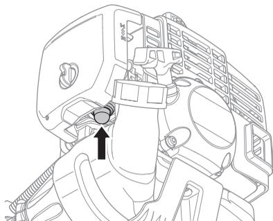
**Aria:** Portare il comando dell'aria in posizione di starter.
