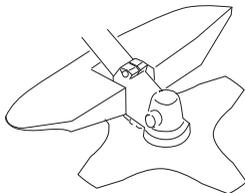
Controllare che la protezione sia integra e priva di incrinature. Sostituire la protezione se è stata sottoposta a urti o se è incrinata.
