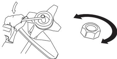
Il blocco di nylon del dado di bloccaggio non deve essere talmente usurato da poter essere girato a mano. Il blocco deve sopportare almeno 1,5 Nm. Quando è stato avvitato circa 10 volte, il dado va sostituito.
