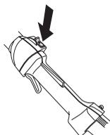
Mettere in moto e controllare che il motore si spenga portando l'interruttore in posizione di arresto.
