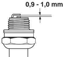
**N.B!** Usare candele originali o di tipo raccomandato! Altre candele possono danneggiare cilindro e pistone. Controllare che la candela sia munita di dispositivo di soppressione interferenze radio.
