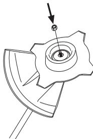
Ao montar, aperte a porca no sentido oposto ao sentido de rotação do equipamento de corte. Para desmontar, desaperte a porca no sentido da rotação do equipamento
