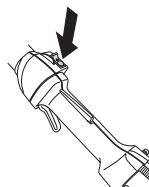
Käivita mootor ja kontrolli, kas mootor seiskub, kui lükkad lülitit seiskamisasendisse.
