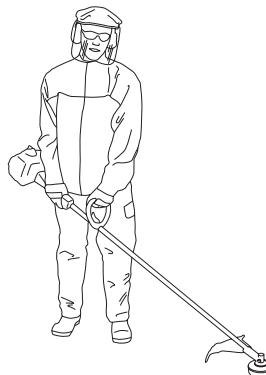
7 Дръжте режещото оборудване под нивото на кръста си.
