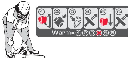
Pretože je brzda reťaze ešte stále zapojená, je nutné čo najskôr znížiť počet otáčok motora na voľnobeh, čoho dosiahnete tým, že vypojíte držák škriaticej klapky plynu. Odpojenie sa vykoná jemným dotykom na spušti škriaticej klapky plynu. Týmto postupom sa zabráni zbytočnému opotrebovaniu spojky, bubna spojky a brzdového pásu. Pred prechodom na maximálne otáčky nechajte stroj na niekoľko sekúnd bežať naprázdno.
