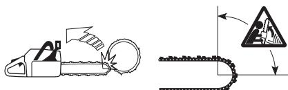
Řezání spodní stranou lišty, tzn. shora dolů, se označuje jako řezání nabíhajícím řetězem. V tomto případě řetěz přitahuje pilu směrem ke stromu a přední část těla pily se při řezání bezprostředně opírá o kmen. Řezání nabíhajícím řetězem poskytuje uživateli lepší kontrolu nad motorovou pilou a polohou oblasti zpětného rázu.
