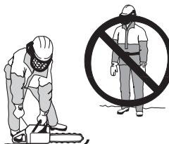
Reťazovú pilu držte vždy oboma rukami. Pravou rukou uchopte zadnú rukováť a ľavou rukou prednú rukováť. **Pílu by takto mal používať všetci užívateľia, praváci a ľaváci.** Rukováť držte pevne tak, aby ste palcami a prstami obopli rukováť reťazovej píly.
