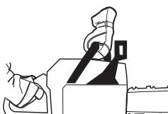
Přidejte plyn, až motorová pila dosáhne plných otáček, a uvedte v činnost brzdu řetězu tlakem levého zápeští dopředu na chránič ruky. Nepouštějte přední rukojet. **Řetěz by se měl okamžitě zastavit.**
