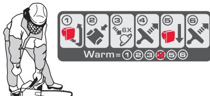
Jelikož je brzda řetězu stále ještě zapojena, je nutno co nejdříve snížit počet otáček motoru na volnoběh, čehož dosáhnete tím, že vypojíte držák škrťicí klapky plynu. Odpojení se provádí lehkým dotykem spouště škrťicí klapky plynu. Tím se vyhnete zbytcnému optřebování spojky, bubny spojky a brzdného pásu. Před přechodem na maximální otáčky nechejte stroj na několik vteřin běžet naprázdno.
