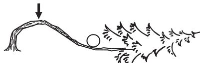
Premyslite si najbezpečnejší spôsob uvoľnenia pnutia a zároveň, či to dokážete bezpečne urobiť. V komplikovaných prípadoch je jedinou bezpečnou metódou odložiť reťazovú pílu a použiť navíjak.
