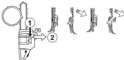
Abiem griezumumiem kopumā jāšķēl apmēram 1/4 stumbra diametru, veidojot apmēram 45 grādu lenķi.
