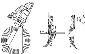
Nogrieziet gāšanas griezumus paralēli ar gāšanas virziena griezumā līniju, atstājot atstarpi, kas atbilst 1/10 stumbra diametram. Stumbra nepārgriezto daļu sauc par laušanas strēmeli.
