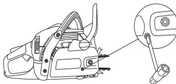
Kett on korrektselt pingutatud, kui see ei ole juhtplaadi alumisel poolel lõtv ja on käega kergelt ringveetav. Keera kinnitusmutrid kombivõtmeaga kinni, samaaegselt juhtplaati üleval hoides.
