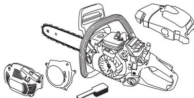
Puhasta jahutussüsteemi kord nädalas harjaga, raskete tööolude puhul tihedamini. Määrdund või ummistunud jahutussüsteemi puhul kuumeneb seade üle, mis vigastab silindrit ja kolbi.
