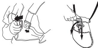
Kontrollera att selens remmar är rätt placerade. När selen och maskinen är justerade, kontrollera att selens snabbutlösning fungerar.
