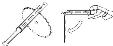
Kontrollera skärutrustningen med avseende på skador och sprickbildning. En skadad skärutrustning ska alltid bytas ut.
