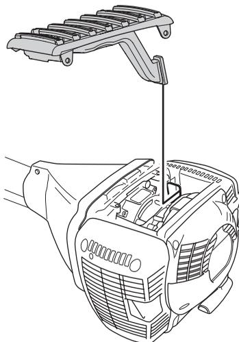
**TÄRKEÄÄ!** Koneeta rakenne ON palautettava normaaliksi, jos lämpötila on yli -5°C tai 0°C. Muussa tapauksessa moottori voi ylikuumeta ja vaurioitua vakavasti.
