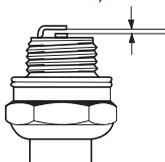
**OBS!** Bruk alltid anbefalt type tennplugg! Feil tennplugg kan ødelegge stempel/sylinder. Påse at tennpluggen har såkalt radiostøyfilter.
