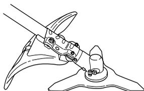
Kontrollér, at beskyttelsen er intakt og fri for revner. Udskift beskyttelsen, hvis den har været udsat for slag eller har revner.
