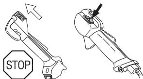
Start motoren og kontroller at motoren blir slått av når stoppbryteren føres til stopstilling.
