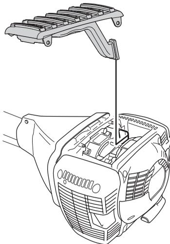
**VIGTIGT!** Ved temperaturer over henholdsvis -5°C og 0°C SKAL maskinen omstilles til normal indstilling. Ellers er der risiko for overophedning med alvorlige motorskader til følge.
