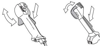
Se anvisningerne under overskriften Start. Start maskinen, og giv fuld gas. Slip gasreguleringen, og kontrollér, at skæreudstyret standser, og at det forbliver i stilstand. Hvis skæreudstyret roterer med gasreguleringen i tomgangsstilling, skal karburatorens
