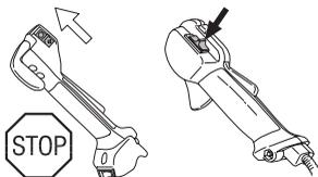
Starta motorn och kontrollera att motorn stängs av när stoppkontakten förs till stoppläget.
