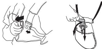
Tarkasta, että valjaiden hihnat on asetettu oikein. Kun valjaat ja kone on säädetty, tarkasta, että valjaiden pikairrotin toimii.
