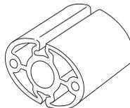
Kontroller regelmessig avvibreringselementene med tanke på materialsprekker og deformering. Kontroller at avvibreringselementene er hele og fast forankret.
