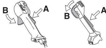
Kontroller at gassregulatoren er låst i tomgangsstilling når gassregulatorsperren er i sin utgangsposisjon.
