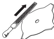
Håll korrekt skränkning på sågklingan! Följ våra instruktioner och använd rekommenderat skränkverktyg. En felaktigt skränt sågklinga ökar risken för fastlåsning och kast samt skador på sågklingan.
