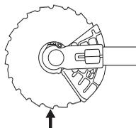
Både når man løsner og når man trekker til mutterne på sagbladet er risikoen til stede at man skader seg på bladets tenner. Påse derfor at hånden befinner seg i ly av bladbeskyttelsen under dette arbeidet. Bruk alltid en pipenøkkel med tilstrekkelig langt skaft for å gjøre dette
