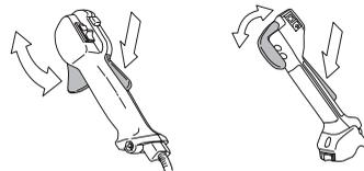
Se anvisninger under overskriften Start. Start maskinen og gi full gass. Slipp gassregulatoren og kontroller at skjærestyret stanser og at det blir stående stille. Hvis skjærestyret roterer når gassregulatoren står i tomgangsstilling må forgasserens tomgangsjustering
