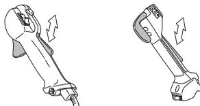
Kontrollera att gasreglaget och gasreglagespärren går lätt samt att deras retur fjädersystem fungerar.
