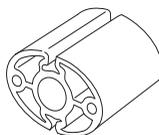
Kontrollera regelbundet avvibreringselementen efter materialsprickor och deformationer. Kontrollera att avvibreringselementen är hela och fast förankrade.
