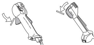
Tryck in gasreglagespärren och kontrollera att den återgår till sitt ursprungsläge när den släpps.
