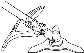
Tarkasta, että suojus on ehjä ja ettei siinä ole halkeamia. Vaihda suojus, jos siihen on kohdistunut iskuja tai siinä on halkeamia.
