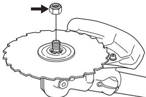
Asennettaessa, kiristä mutteri terälaitteen pyörimissuuntaa vastaan. Irrotettaessa, irrota mutteri terälaitteen pyörimissuuntaan. (HUOM! Mutterissa on vasenkätinen kierre.) Raivausterän mutteria avattaessa ja kiristettäessä on aiheuttavat raivausterän hampaat tapaturmavaaran. Pidä sen vuoksi kätesi teränsuojuksen takana tämän työn aikana. Tämä on mahdollista, kun käytät aina riittävän pitkällä varrella varustettua hylsyavainta. Kuvan nuoli osoittaa, millä alueella
