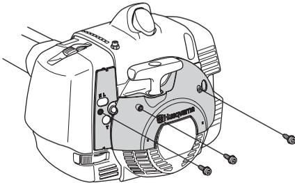
Demonter maskinens luftfilter og luftfilterlokk. Monter det luftfilteret og luftfilterlokket som følger med vintersettet.
