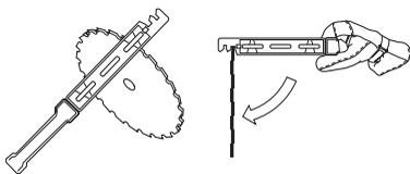
Tarkasta terälaitte vaurioiden ja halkeamien varalta. Vaurioitunut terälaitte on aina vaihdettava.
