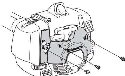
Ota koneen ilmansuodatin ja ilmansuodattimen kansi pois. Asenna talvisarjan mukana toimitettu ilmansuodatin ja ilmansuodattimen kansi.
