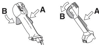
Kontrollér, at gasreguleringen er låst i tomgangsstilling, når gasreguleringslåsen befinder sig i udgangsstilling.
