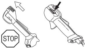
Käynnistä moottori ja tarkasta, että moottori pysähtyy, kun pysäytin siirretään pysäytysasentoon.
