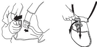
Kontrollér, at selens remme er korrekt placeret. Når selen og maskinen er justeret, skal det kontrolleres, at selens snapudløsning fungerer.
