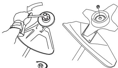
Låsemøtrikkens nylonlås må ikke være så slidt, at den kan drejes med fingrene. Låsen skal holde mindst 1,5 Nm. Møtrikken skal udskiftes, når den har været skruet på ca. 10 gange.
