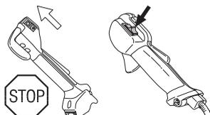
Start motoren, og kontrollér, at motoren slukkes, når stopkontakten sættes i stopposition.
