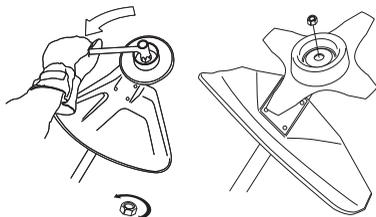
Låsemutterens nylonlåsing må ikke være så slitt at den kan skrues med fingrene. Låsingen må holde minst 1,5 Nm. Mutteren må skiftes etter at den har vært skrudd på ca. 10 ganger.
