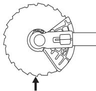
Ved løsning eller fastspænding af savklingens møtrik er der risiko for at skære sig på savklingens tænder. Sørg derfor for, at hånden er beskyttet af klingebeskyttelsen under dette arbejde. Brug altid en topnøgle med tilstrækkeligt langt skaft for at gøre dette muligt. Pilen på
