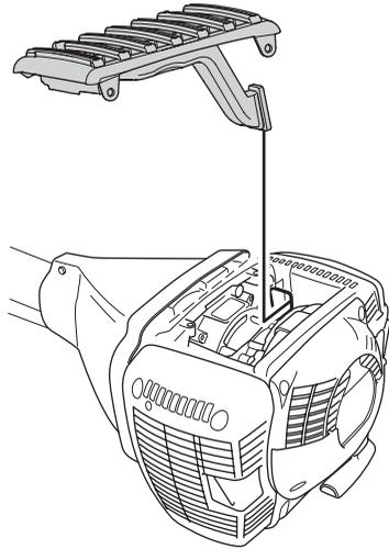
**VIGTIG!** Ved temperaturer over henholdsvis -5°C og 0°C SKAL maskinen omstilles til normal innstilling. Hvis ikke, risikerer man overoppheting med store skader på motoren som følge.
