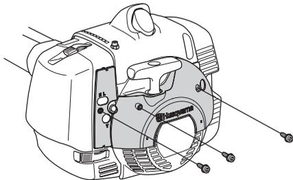
Afmonter maskinens luftfilter og luftfilterdæksel. Monter det luftfilter og luftfilterdæksel, der følger med vintersættet.
