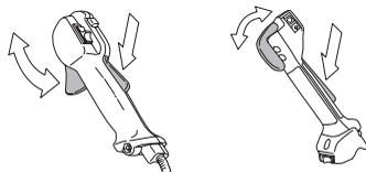
Se anvisningar under rubrik Start. Starta maskinen och ge full gas. Släpp gasreglaget och kontrollera att skärutrustningen stannar och att den förblir stillastående. Om skärutrustningen roterar med gasreglaget i tomgångsläge ska förgasarens tomgångsjustering kontrolleras. Se anvisningar under rubrik Underhåll.
