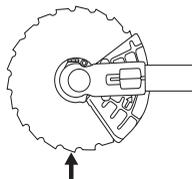
Vid lossdragning och åtdragning av sågklingans mutter finns risk för att skada sig på sågklingans tänder. Se därför till att handen befinner sig i skydd av klingskyddet vid detta arbete. Använd alltid en hylsnyckel med tillräckligt långt skaft för att möjliggöra detta. Pilen på bilden visar inom vilket område hylsnyckeln ska arbeta vid loss- respektive åtdragning av muttern.
