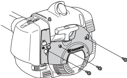
Demontera maskinens luftfilter och luftfilterlock. Montera det luftfilter och luftfilterlock som medföljer vintersatsen.
