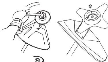
Låsmutterns nylonlåsning får ej vara så sliten att den kan skruvas med fingrarna. Låsningen ska hålla minst 1,5 Nm. Muttern ska bytas efter det att den skruvats på ca 10 gånger.
