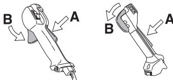
Kontrollera att gasreglaget är låst i tomgångsläge när gasreglagespärren är i sitt ursprungsläge.
