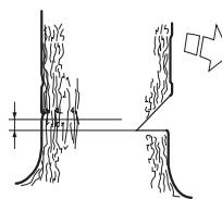
Sätt i barkstödet (om något är påmonterat) bakom brytmånen. Såga med fullgas och för sågkedjan/svärdet sakta in i trädet. Var observant på om trädet rör sig i motsatt riktning till vald fallriktning. Sätt i en fällkil eller ett brytjärn i fällskäret så snart skärdjupet tillåter.
