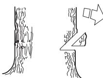
Riktskärsdjupet skall vara  $1/4$  av stamdiametern och vinkeln mellan över- och underskär minst  $45^\circ$ .
