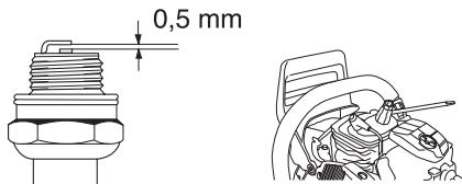
Notera! Använd alltid rekommenderad tändstiftstyp! Felaktigt tändstift kan förstöra kolv/cylinder. Se till att tändstiftet har s.k. radioavstörning.
