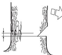
Sett i barkstøtten (hvis en slik er montert) bak brytekanten. Sag med full gass og før sagkjedet/sverdet sakte inn i treet. Vær på vakt mot at treet beveger seg i motsatt retning av det som er valgt som fallretning. Sett i en fellekile eller et brytejern i hovedskåret så snart skjæredybden tillater det.
