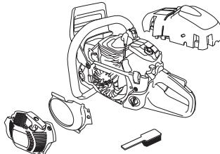
Rengjør kjølesystemet med en børste en gang i uken, ved vanskelige forhold oftere. Et tilsnusset eller tett kjølesystem fører til at maskinen overopphetes, noe som forårsaker skader på cylinder og stempel.
