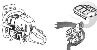
**VIGTIGT!** For at bevare centrifugalrensningens funktion skal man udføre kontinuerlig pleje og vedligeholdelse. Rens startaggregatets luftindtag, svinghjulets ventilatorflanger, området omkring svinghjulet, indugsningsrøret og karburatorrummet.
