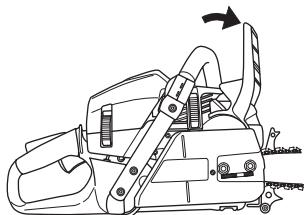
**Tænding; choker:** Sæt chokeren i chokerstilling. Stopkontakten indstilles herefter automatisk til startposition.
