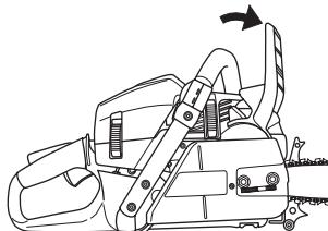
**Tändning; choke:** Ställ chokereglaget i chokeläge. Stoppkontakten skall då automatiskt ställas i startposition.
