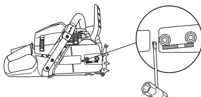
Ketjun kireys on oikea, kun se ei roiku lösällä terälevyn alapuolella ja liikkuu kevyesti käsin pyörittäässä. Kiristä terämutterit yhdistelmäävaimella pitäen samalla terälevyn kärkeä ylhäällä.
