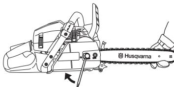
Uuden ketjun kireys on tarkastettava usein ketjun sisäänajon aikana. Tarkasta ketjun kireys säännöllisesti. Oikein kiristetty ketju takaa hyvän leikkuutehon ja pitkän kestojan.
