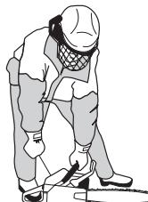
Tryck in chokereglaget omedelbart när motorn tänds och gör förynade startförsök tills motorn startar. När motorn startar, ge snabb fullgas och startgasen kopplas automatiskt ur.
