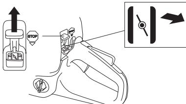
**Käynnistyskaasu:** Yhdistetty rikastus/käynnistyskaasusatento saadaan siirtämällä säädin rikastusasentoon.
