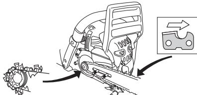
Tarkasta, että hammaslenkien teräsärmät ovat eteenpäin terälevyn yläpuolella.
