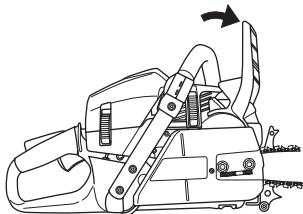
**Tenninng; choke:** Still chokehendelen i chokesetting. Stoppbryteren skal da stilles automatisk på startposisjon.
