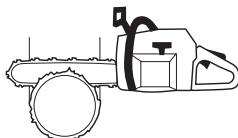
Käytössä on menetelmä, joilla voidaan kaataa terälevyn pituutta paksumpia puita. Näitä menetelmiä käytettäessä on erittäin suuri vaara, että terälevyn takapotkusektori osuu johonkin.
