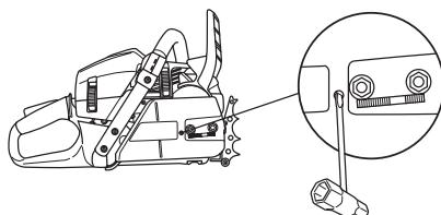
Kæden er korrekt spændt, når den ikke hænger slapt ned på sværdets underside og stadig kan trækkes rundt med hånden. Spænd sværdmøtrikkerne fast med kombinøglen, samtidig med at sværdspidserne holdes opad.
