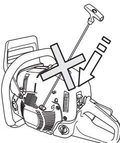
Notera! Återställ kedjebromsen genom att föra kastskyddet mot handtagsbygeln. Motorsågen är härmed klar för användning.
