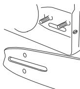
Spænd kæden ved at bruge kombinøglen til at skru kædestrammerskruen med uret. Kæden skal strammes til, så den ikke hænger slapt ned på sværdets underside.
