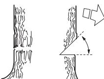
Ylä- ja alasahauksen kohtaamispistettä kutsutaan kaatolovilinjaksi. Kaatolovilinjan on oltava tarkasti vaakasuorassa ja muodostettava samalla suora kulma ( $90^\circ$ ) valittuun kaatosuuntaan nähdäen.
