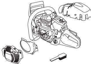
Rens kølesystemet med en børste en gang om ugen, under støvfyldte forhold oftere. Et snavset eller tilstoppet kølesystem medfører overopvarmning af maskinen med skader på cylinderen og stemplet til følge.
