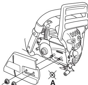
Asenna terälevy teräpultteihin. Aseta terälevy takimmaiseen asentoonsa. Aseta ketju ketjupöyrälle ja terälevyn ohjausaraan. Aloita terälevyn yläpuolella.
