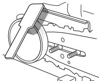
Kontroller jevnlig at bremsebåndet er minst 0,6 mm tykt på det mest slitte stedet.
