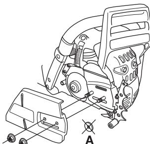
Montér sværdet over sværboltene. Placér sværdet i dets bagerste stilling. Placér kæden over kædedrivhjulet og i sværdsporet. Begynd på sværdets overside.
