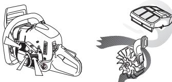
TÄRKEÄÄ! Keskipakoispuhdistuksen tehon säilyttämiseksi on huolehdittava säännöllisestä huollossa. Puhdista käynnistimen ilmanottoaukot, vauhtipyörän tuuletinsiivet, vauhtipyörän ympäristö, imuputki ja kaasutintila.
