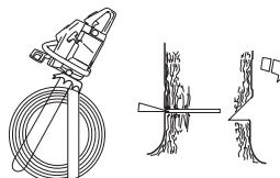
Fældesnittet skal afslutes parallelt med retningssnitlinjen, så afstanden mellem de to er mindst 1/10 af stammens diameter. Den ikke gennemsavede del af stammen kaldes brudpunktet.
