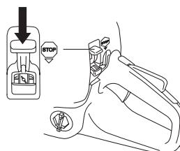
Motoren standses ved at anbringe stopknappen i stopstilling.
