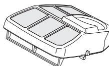
Et filter som har vært mye brukt kan aldri bli fullstendig rent. Derfor må det skiftes med jevne mellomrom. **Et skadet luftfilter må alltid skiftes.**
