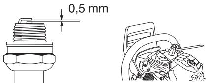
Bemerk! Bruk alltid anbefalt type tennplugg! Feil tennplugg kan ødelegge stempel/sylinder. Påse at tennpluggen har såkalt radiostøyfilter.
