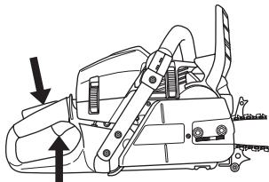
OBS! Dra ikke startsnoren helt ut og slipp heller ikke håndtaket fra helt utdratt stilling. Dette kan skade maskinen.
