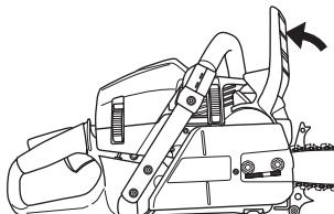
Ruuvaa terämutterit irti ja irrota kytkinkotelo (ketjupuoli). Poista kuljetussuoja (A).
