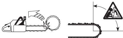
Å sage med sverdets underside, dvs. å sage fra sagobjektets overside og ned, kalles å sage med dragende sagkjede. Da dras motorsagen mot treet, og motorsagkroppens forkant blir en naturlig støtte mot stammen. Saging med dragende sagkjede gir brukeren bedre kontroll over motorsagen og over hvor sverdets kastrisikosektor befinner seg.
