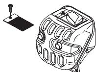
Lyddæmperen er beregnet til at dæmpe lydniveauet og til at lede udstødningsgasserne væk fra brugerne. Udstødningsgasserne er varme og kan indeholde gnister, som kan forårsage brand, hvis udstødningsgasserne rettes mod et tørt og brændbart materiale.
