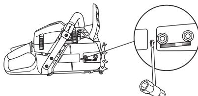
Kedjan är korrekt spänd när den inte hänger slak på svärdets undersida och fortfarande kan dras runt lätt för hand. Drag fast svärdsmuttrarna med kombinyckeln samtidigt som svärdspetsen hålls upp.
