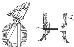
Hovedskåret skal avsluttes parallelt med styreskållinjen slik at avstanden mellom dem er minst 1/10 av stammens diameter. Den delen av stammen som ikke er gjennomsagd, kallas brytekant.
