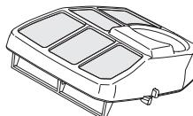
Et længe brugt luftfilter kan aldrig blive helt rent. Derfor skal filteret regelmæssigt udskiftes med et nyt. **Et beskadiget luftfilter skal altid udskiftes.**
