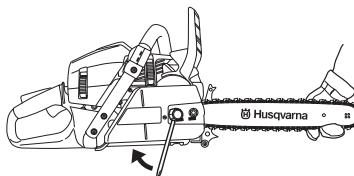
På en ny kæde skal kædestramningen kontrolleres ofte, indtil kæden er kørt til. Kontrollér kædestramningen regelmæssigt. Korrekt kæde betyder god skærekapacitet og lang levetid.
