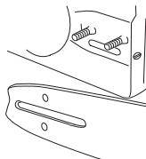
Kiristä ketju kiertämällä ketjun kiristysruuvia yhdistelmäävaimella myötäpäivään. Ketju on kiristettävä sen verran, ettei se roiku lösällä terälevyn alapuolella.
