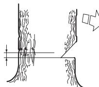
Placer barkstøtten (hvis den er monteret) bag brudpunktet. Sav med fuld gas, og før savkæden/sværdet langsomt ind i træet. Vær opmærksom på, om træet bevæger sig i modsat retning i forhold til den valgte faldretning. Sæt en fældekile i eller et brækjern i fældesnittet, så snart snitdybden tillader det.
