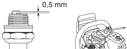
Bemærk! Brug altid anbefalet tændrørstype! Forkert tændrør kan ødelægge stempel/cylinder. Kontrollér, at tændrøret har såkaldt radiostøjdæmpning.
