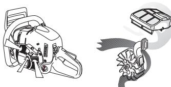
**VIGTIG!** For å opprettholde centrifugalrensingens funksjon, må den rengjøres og vedlikeholdes kontinuerlig. Rengjør luftinntaket til startmotoren, vifteskovlene på svinghjulet, rommet rundt svinghjulet, intaksrøret og forgasserrommet.
