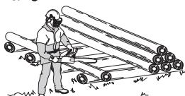
**Stokken ligger på bakken.** Det er ingen fare for at sagkjedet skal klemmes fast eller at sagobjektet skal splinters. Det er imidlertid stor fare for at sagkjedet treffer bakken etter gjennomsaging.
