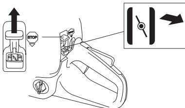
**Startgas:** Kombinerat choke/startgasläge erhålls när reglaget ställs i chokeläge.
