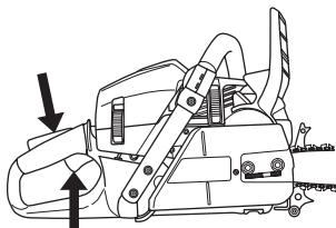
**BEMÆRK!** Træk ikke startsnoren helt ud, og slip heller ikke starthåndtaget fra udstrakt stilling. Dette kan give skader på maskinen.
