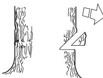
Retningssnitybden skal være 1/4 af stammens diameter, og vinklen mellem over- og undersnit skal være mindst 45°.
