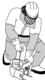
Jakmile motor naskočí (uslyšíte „bafnutí“), zamáčkněte tlačítko sytiče. Dúrazně tahejte za startovací šňůru, dokud motor nenastartuje. Po nastartování motoru rychle přidejte
