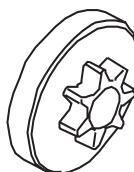
Pravidelně kontrolujte úroveň opotřebení hnacího řetězového kolečka. Vyměňte jej, pokud je nadměrně opotřebené. Vyměňte hnací řetězové kolečko při každé výměně řetězu.
