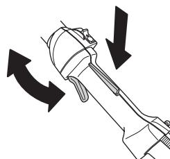
Se anvisningerne under overskriften Start. Start hækkeklipperen, og giv fuld gas. Slip gasreguleringen, og kontrollér, at knivene standser, og at de bliver stående stille. Hvis knivene beveger sig med gasreguleringen i tomgangsstilling, skal karburatorens tomgangsindstilling justeres. Se anvisningerne under overskriften Vedligeholdelse.
