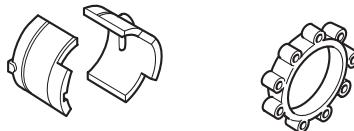
Kontrollera regelbundet avvibreringselementen efter materialsprickor och deformationer. Kontrollera att avvibreringselementen är hela och fast förankrade.
