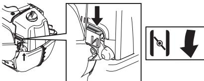
Paina koneen runkoo maata vasten vasemmalla kädellä (HUOM! Ei jalalla!). Tartu käynnistyskahvasta, vedä käynnistysnarusta hitaasti oikealla kädellä, kunnes tunnet vastuksen (kytkentäkynnet tarttuvat) ja vedä sen jälkeen nopein ja voimakkain vedoin.
