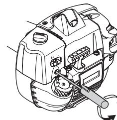
Knivene skal heller ikke bevege seg med chokeregulatoren i startgasstilling.
