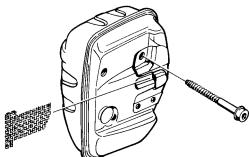
På ljuddämpare utan katalysator bör näset rengöras och eventuellt bytas en gång per vecka. På katalysatorljuddämpare skall näset kontrolleras och eventuellt rengöras en gång per månad. **Vid ev. skador på näset ska detta bytas.** Om näset ofta är igensatt, kan detta vara ett tecken på att katalysatorns funktion är nedsatt. Kontakta din återförsäljare för kontroll. Med ett igensatt nät överhettas maskinen med skador på cylinder och kolv som följd. Se även anvisningar under rubrik Underhåll.
