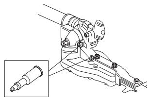
**BEMÆRK!** Gearet skal ikke fyldes helt med fedt. Fedtet udvides af den varme, som opstår, når maskinen kører. Hvis gearet var helt fyldt med fedt, er der risiko for ødelagte pakninger og fedtlækage.
