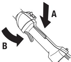
Kontrollera att gasreglaget är låst i tomgångsläge när gasreglagespärren är i sitt ursprungsläge.
