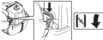
Trykk maskinkroppen mot bakken med venstre hånd (OBS! Ikke med foten!). Ta tak i starthåndtaket med høyre hånd og dra langsomt ut startsnoren til du merker motstand (starthakene griper inn) og trekk deretter raskt og kraftig til.
