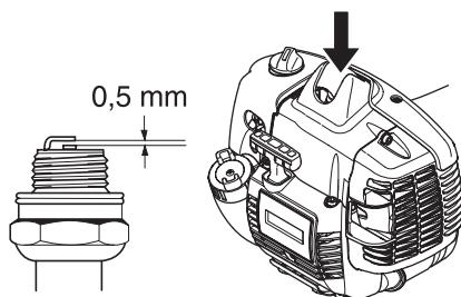
**OBS!** Bruk alltid anbefalt type tennplugg! Feil tennplugg kan ødelegge stempel/sylinder. Påse at tennpluggen har såkalt radiostøyfilter.
