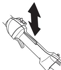
Kontrollera att gasreglaget och gasreglagespärren går lätt samt att deras returfjädersystem fungerar.
