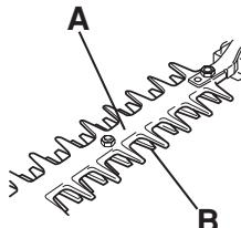
Kontrollera knivskyddet så att det är oskadat och utan deformeringar. Byt knivskyddet om det är böjt eller skadat.
