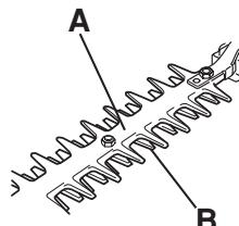
Kontrollér, at knivbeskyttelsen hverken har skader eller deformeringer. Udskift knivbeskyttelsen, hvis den er bøjet eller beskadiget.
