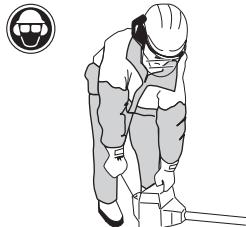
**OBS!** Ikke plasser noen del av kroppen på den markerte flaten. Berøring kan medføre brannskader på huden eller elektrisk støt dersom tennplughetten er defekt. Bruk alltid hansker. Bruk aldri en maskin med defekt tennplughette.
