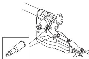
**HUOM!** Vaihdetta ei saa täyttää aivan täyneen rasvalla. Rasva laajenee koneen käytön aikana kehittyvän lämmön vaikutuksesta. Jos vaihde on aivan täynnä rasvaa, on olemassa tiivisteiden vaurioitumisen ja rasvavuodon vaara.
