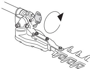
**VARNING!** Greppa inte om klippaggregatet när du skall ställa in vinkeln. Knivarna är vassa och skärskador kan lätt uppstå.
