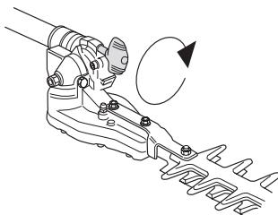
**ADVARSEL!** Tag ikke fat omkring klippeaggregatet, når du skal indstille vinklen. Knivene er skarpe, og snitsår kan let opstå.
