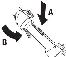
Kontroller at gassregulatoren er låst i tomgangsstilling når gassregulatorsperren er i sin utgangsposisjon.
