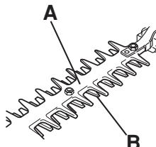
Kontroller knivbeskyttelsen med henblikk på skader og sprekkdannelse. Skadet knivbeskyttelse må alltid skiftes.
