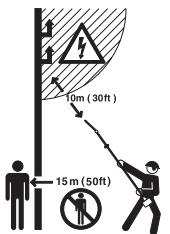
Elektrisitet kan også overføres gjennom grener og andre gjenstander, spesielt dersom de er våte. Hold alltid en avstand på minst 10 m mellom maskinen og spenningsførende ledning og/eller gjenstander som står i kontakt med denne. Hvis du må arbeide med kortere sikkerhetsavstand, kontakt alltid aktuelt kraftselskap for å sikre at spenningen er avslått før du påbegynner arbeidet.
