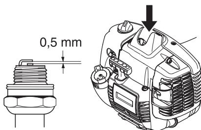
**OBS!** Använd alltid rekommenderad tändstiftstyp! Felaktigt tändstift kan förstöra kolv/cylinder. Se till att tändstiftet har s.k. radioavstörning.
