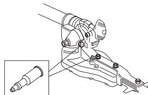
**OBS!** Växeln ska ej fyllas helt med fett. Fettet expanderas av den värme som uppstår när maskinen körs. Skulle växeln vara helt fylld med fett finns det risk för förstörda tätningsar och fettläckage.
