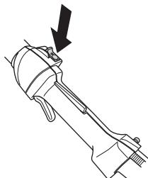
**HUOM!** Pysäytyskosketin palautuu automaatisesti käynnistysasentoon. Sen vuoksi, tahattoman käynnistyksen estämiseksi, sytytystulpan suojuus on aina irrotettava sytytystulpasta asennuksen, tarkastuksen ja/ tai huollon ajaksi.
