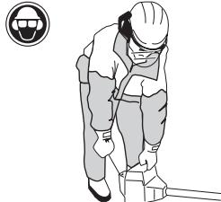
**OBS!** Placera inte någon del av kroppen på den markerade ytan. Kontakt kan resultera i brännskador på huden eller elektrisk stöt om tändhatten är defekt. Använd alltid handskar. Använd aldrig en maskin med defekt tändhatt.
