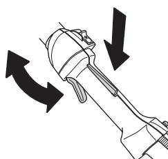
Se anvisningar under rubrik Start. Starta häcksaxen och ge full gas. Släpp gasreglaget och kontrollera att knivarna stannar och förblir stillstående. Om knivarna rör sig med gasreglaget i tomgångsläge skall förgasarens tomgång justeras. Se anvisningar under rubrik Underhåll.
