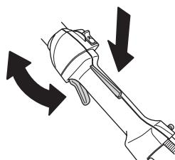
Se anvisninger under Start. Start hekksaksen og gi full gass. Slipp gassregulatoren og kontroller at knivene stanser og forblir stående stille. Hvis knivene beveger seg når gassregulatoren står i tomgangsstilling, må forgasserens tomgang kontrolleres. Se anvisninger under Vedlikehold.
