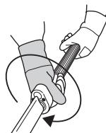
**OBS!** När stoppläget passerats är knivarna blockerade, försök inte att klippa med klippaggregatet i detta läge.
