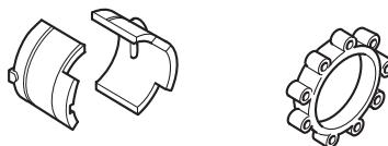
Kontroller regelmessig avvibreringselementene med tanke på materialsprekker og deformering. Kontroller at avvibreringselementene er hele og fast forankret.
