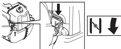
Plaquer la machine contre le sol à l'aide de la main gauche (NOTA! Pas à l'aide du pied!). Saisir ensuite la poignée de démarrage de la main droite et tirer lentement sur le lanceur jusqu'à ce qu'une résistance se fasse sentir (les cliquets d'entraînement grippent), puis tirer énergiquement et rapidement sur le lanceur.
