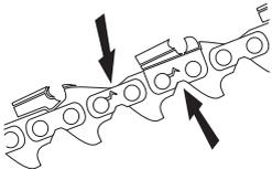
Il est recommandé de comparer avec une chaîne neuve pour évaluer le degré d'usure.
