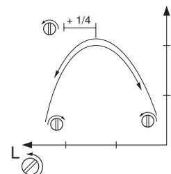
**REMARQUE!** Si l'équipement de coupe tourne au ralenti, tourner le pointeau de ralenti T dans le sens contraire des aiguilles jusqu'à l'arrêt de l'équipement de coupe.
