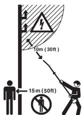
La machine a une longue portée. Vérifier qu'aucune personne et qu'aucun animal ne se trouvent à moins de 15 mètres quand la machine est utilisée.
