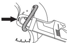
Lors du remplacement d'un disque découpeur par un disque neuf, contrôler les rondelles d'accouplement et l'arbre d'entraînement. Voir les indications à la section Contrôle de l'arbre d'entraînement et des rondelles d'accouplement.
