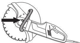
Si une lame diamant est montée sur la découpeuse, veiller à ce qu'elle tourne dans la direction indiquée par la flèche sur la lame.
